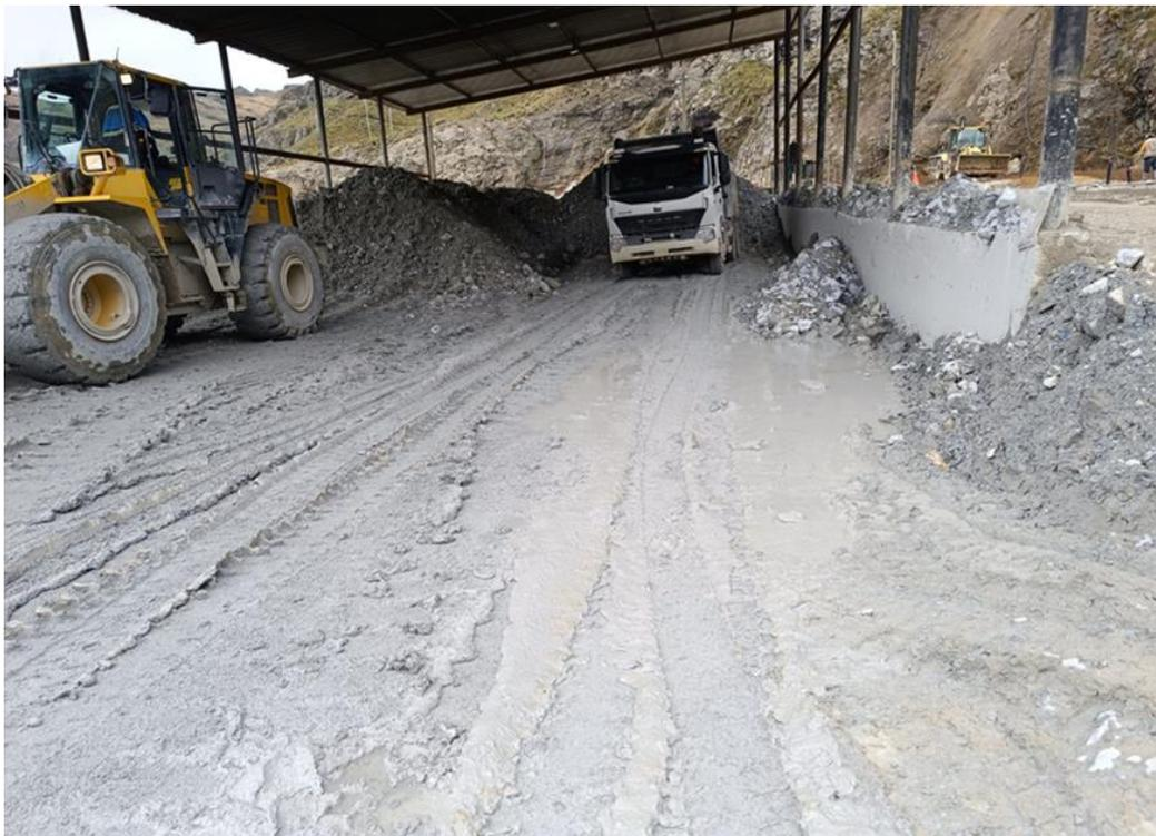
*Figura 10. Descarga de mineral con volquetes 12 m<sup>3</sup>
