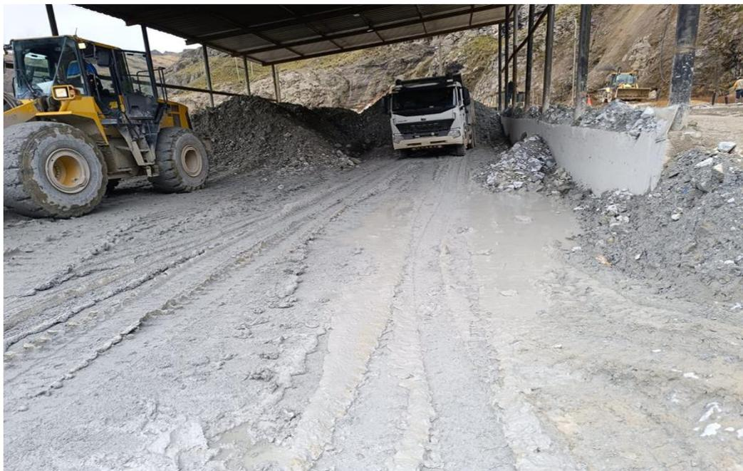
*Figura 10. Descarga de mineral con volquetes 12 m<sup>3</sup>
