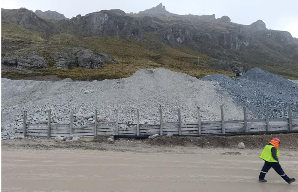
*Figura 9. Cancha de mineral para su mezcla
