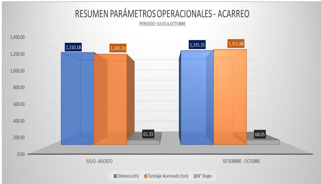
**Figura 34. Validación variables operacionales en equipos acarreo, volquetes 12 m<sup>3</sup>**
