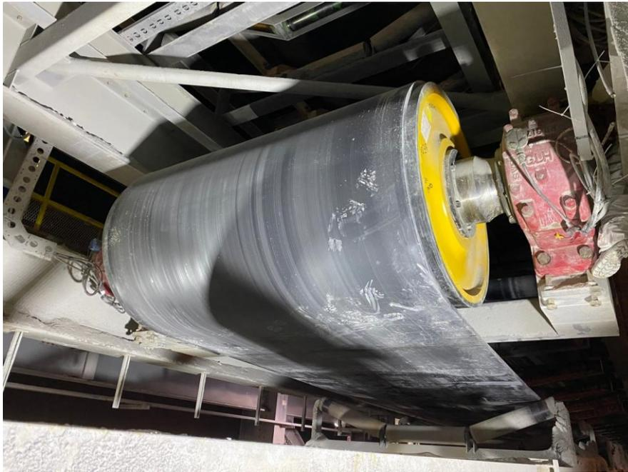
Figura 13. *Polea de volteo de una faja transportadora de mineral. Foto tomada en planta concentradora C2.*
