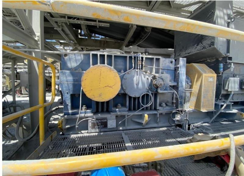
Figura 12. *Caja reductora de una faja transportadora. Imagen tomada en planta concentradora C2.*
