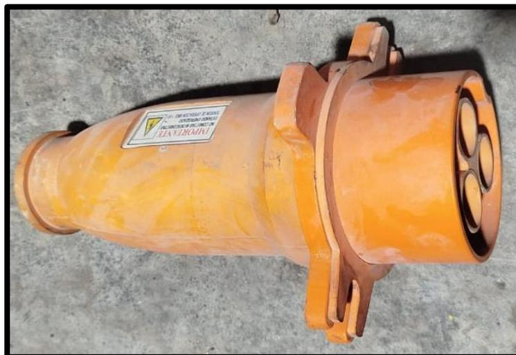
Figura 22. *Conectores pentapolares*
