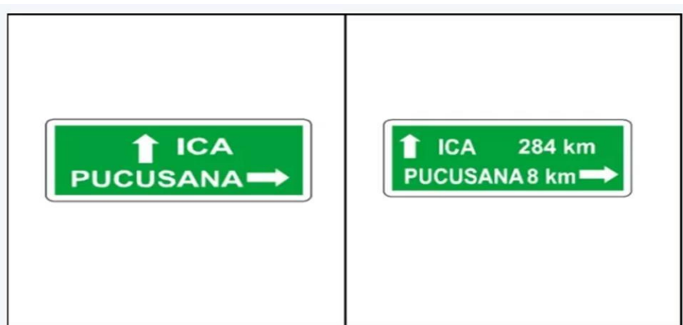
Fig. 07. Señal de destino y señal de destino con distancia
