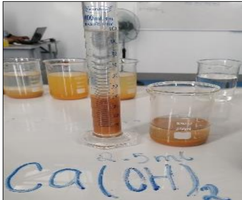
Foto 5. Tiempo de sedimentación con dosificación ideal de 2,5 ml de contenido de cal
