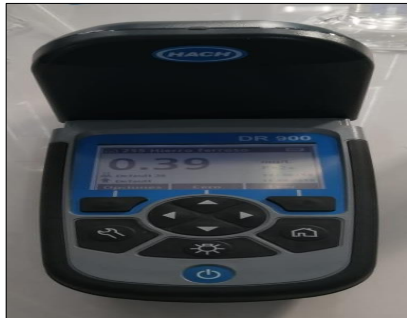
Foto 6. Resultados del colorímetro: en el primer análisis, la cantidad de Fe superaba el rango de medición del equipo; en el segundo análisis, la cantidad de Fe era de 0,39 mg/l, lo cual estaba dentro de los LMP
