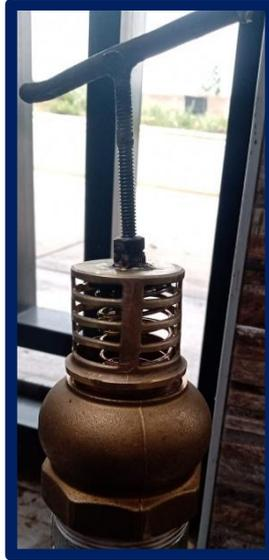
**Ilustración 4.9.** Válvula check modificada.
