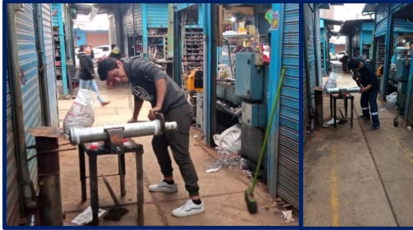
**Ilustración 4.6.** Ensamble de la bomba de ariete.
