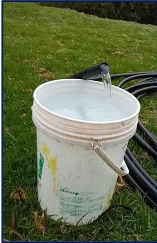
**Ilustración 4.20.** Caudal descargado por la bomba de ariete.
