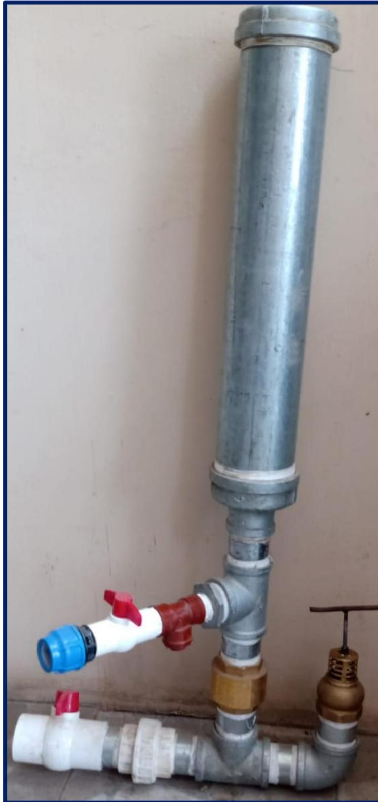
**Ilustración 4.17.** Bomba de ariete ensamblada.
