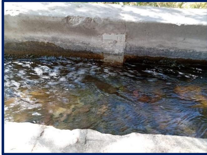
**Ilustración 4.12.** Caudal del canal de alimentación 13-05-2023  $Q=162000$  l/h.
