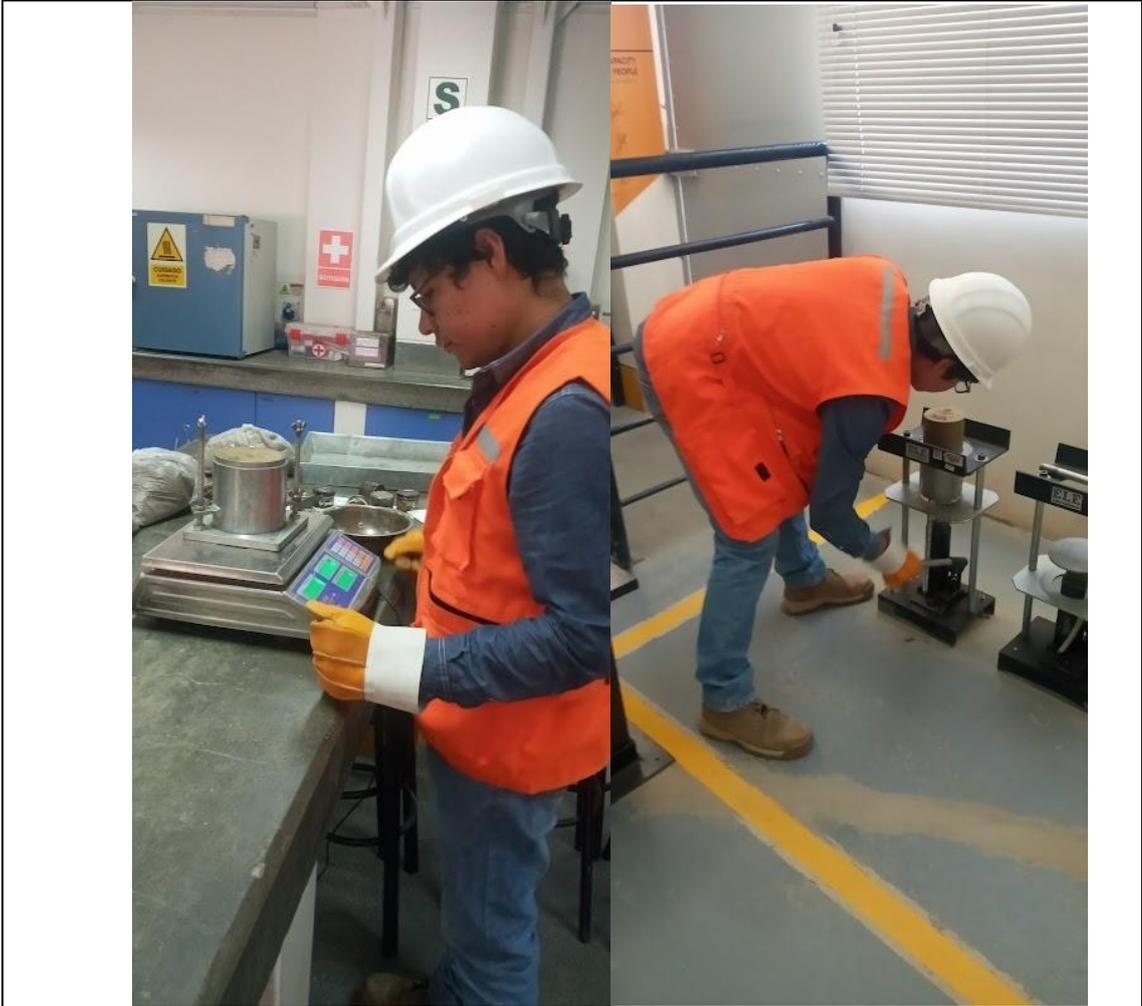
Determinar el peso y extracción de la muestra.
