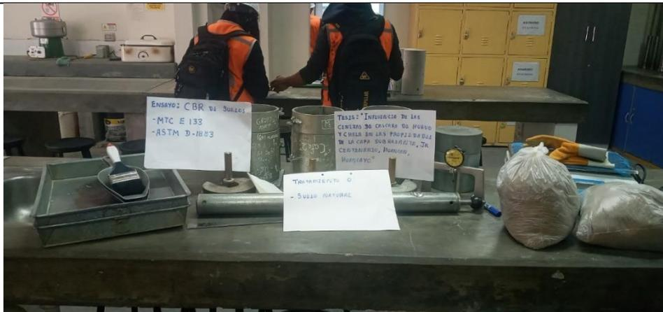
Muestras y materiales para ensayo de CBR.
