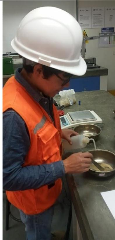
Mezclado de la ceniza y adición de agua hasta obtener una muestra plástica.
