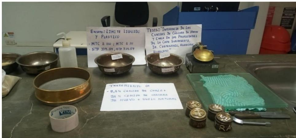
Materiales e insumos para realizar el ensayo de límite líquido y plástico
