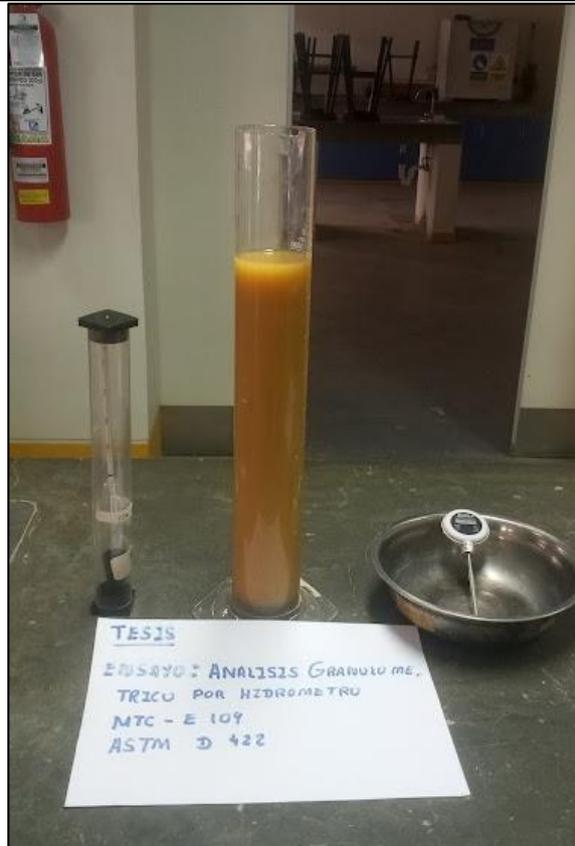
Materiales para realizar el ensayo de analisis granulometrico con el hidrometro
