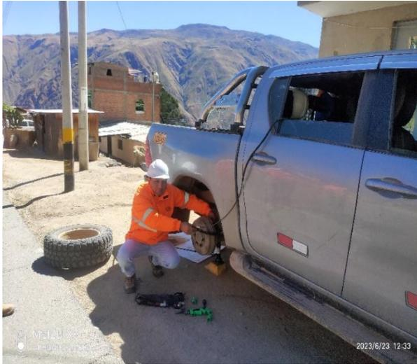
Conexión del acelerómetro a través del Cable de datos (8 m de largo).
