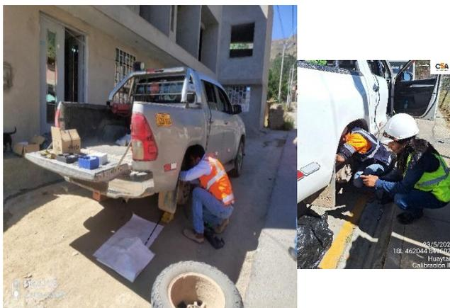
Montaje de acelerómetro en el vehículo en la rueda trasera
