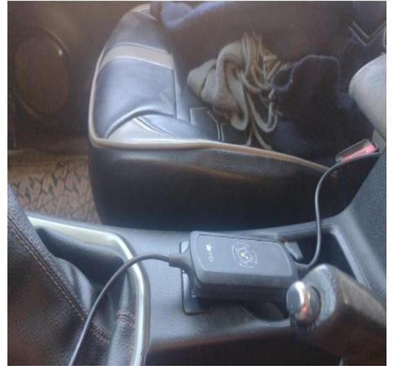
Conexión a la computadora del automóvil a través del bus de diagnóstico a bordo (OBDII)
