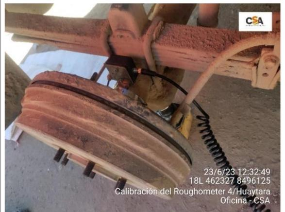
Cable de instalación de montaje del acelerómetro (0,4 m de largo, rizado)
