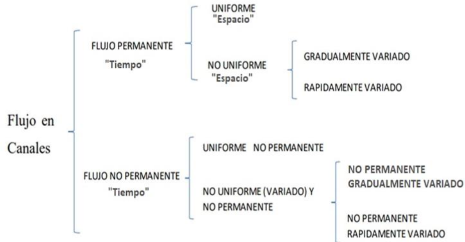
Figura 9. Esquematzación de los tipos de flujos en canales (Villón, 2007).
