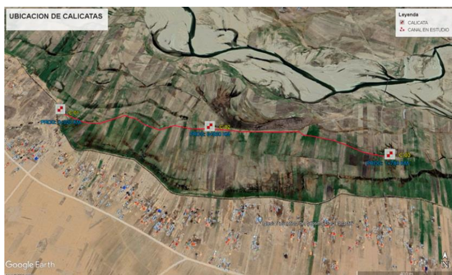
Figura 24. Ubicación de calicatas durante todo el trayecto del canal 0+000km-1+796km
