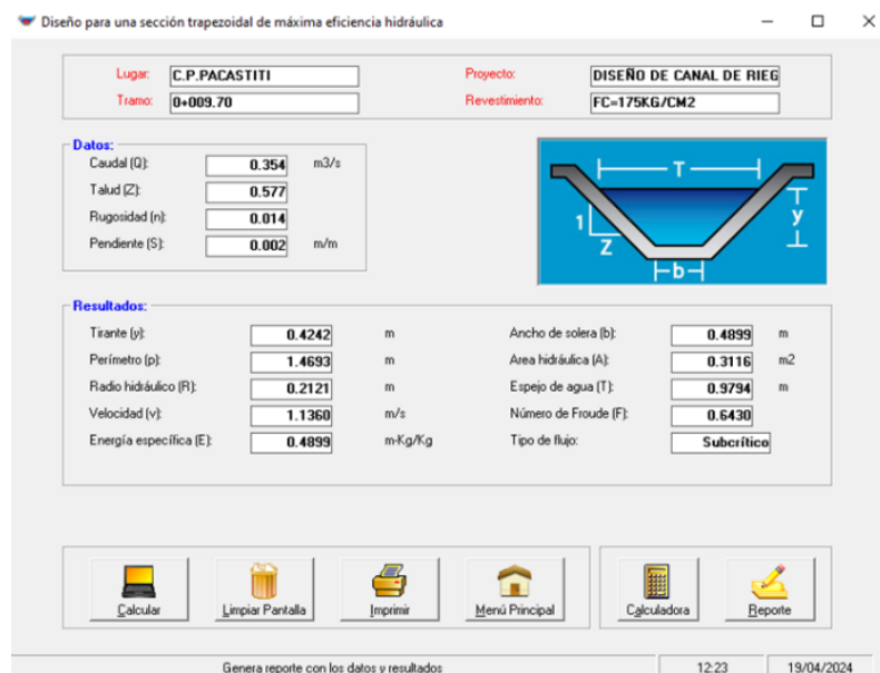
Figura 30. Sección típica del canal trapezoidal
