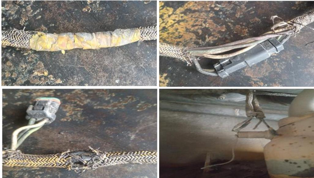
Figura 19. Estado de los cables en mal estado del TA 97. Tomada en el área de operaciones mina de Cuajone.2024, 30 Setiembre.
