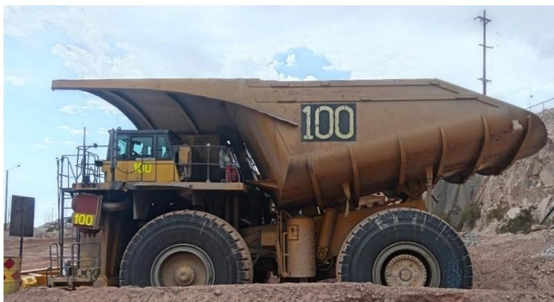
Figura 10. *Camión minero eléctrico Komatsu 930. Tomada en el área de operaciones mina de Cuajone.2024, 28 diciembre.*
