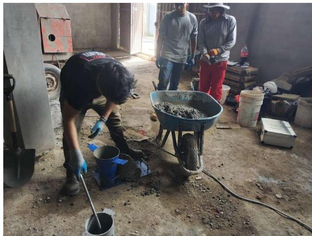
Producción de testigos de concreto para ensayo.
