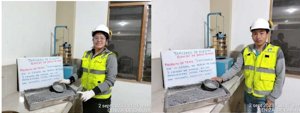
Realización de ensayo de granulometría del agregado.
