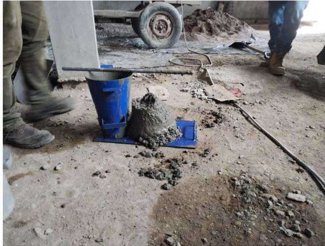
Prueba de slump en concreto húmedo.
