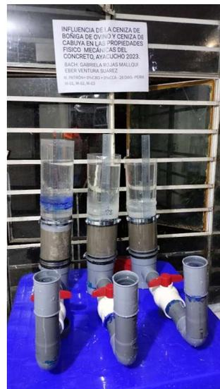
Ensayo de permeabilidad de concreto – 28 días.
