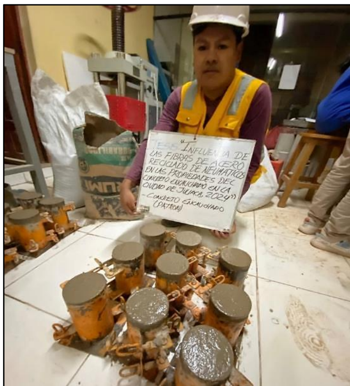
Figura 62. Moldeo de los testigos del concreto encauchado (Patrón).
