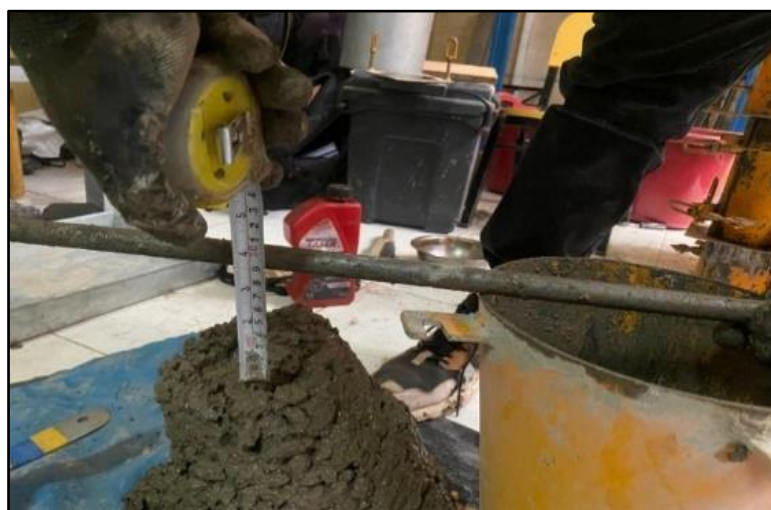
Figura 58. Medida del asentamiento del Concreto.
