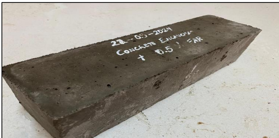
Figura 68. Concreto de sección tipo viga, para el ensayo de resistencia a la Flexión del concreto encauchado (Patrón) + 0.5% de FAR.
