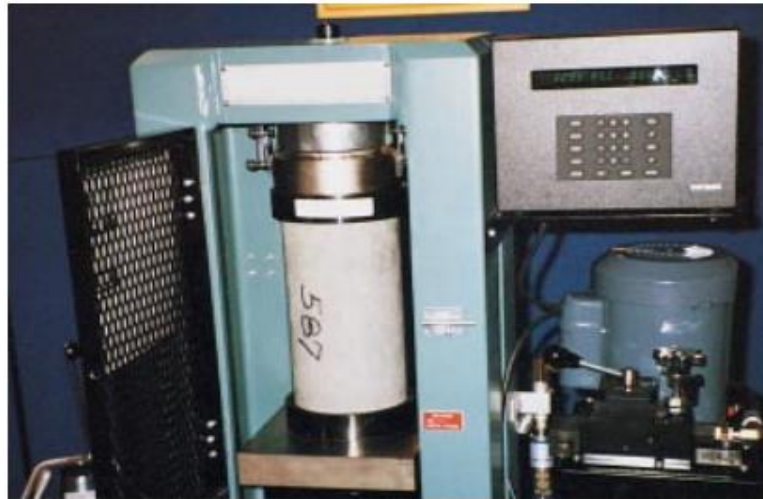
Figura 12. Equipo para el ensayo de compresión del concreto. Tomado de “Diseño y control de mezclas de concreto”, Kosmatka, 2004, p. 9.
