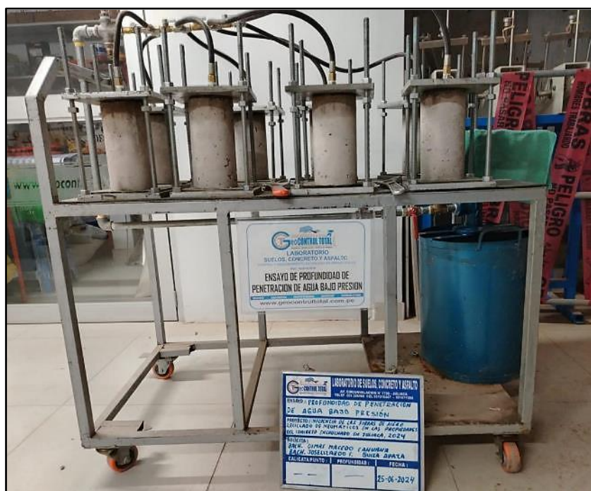
Figura 71. Aplicación de agua a presión a los testigos de concreto designados para el ensayo de permeabilidad por 72 hrs.
