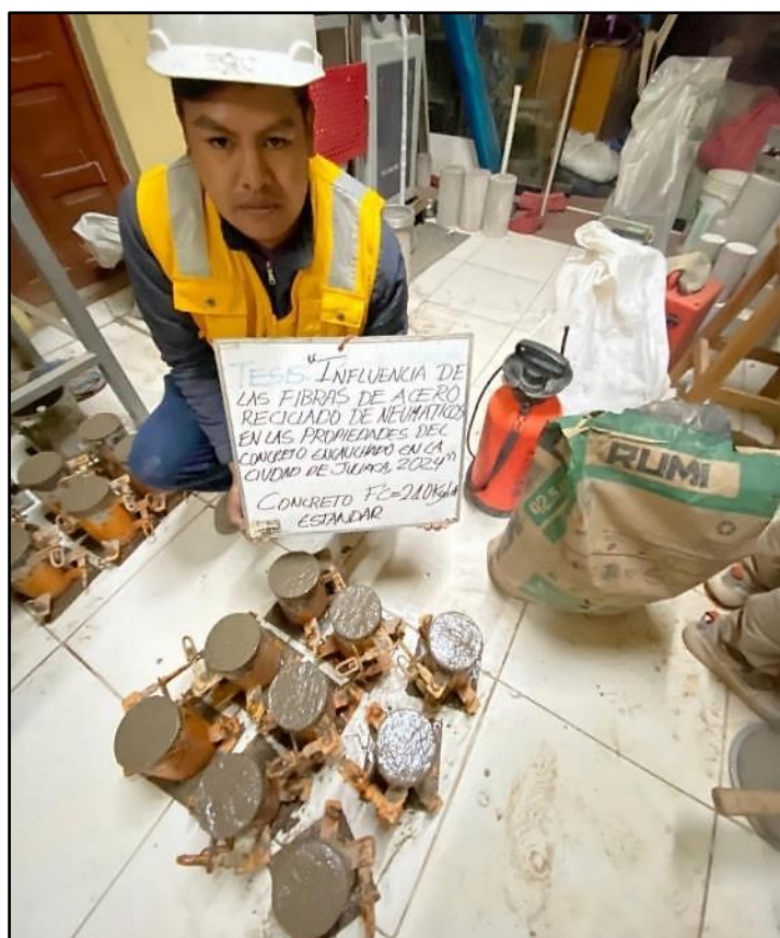
Figura 64. Moldeo de los testigos del concreto estándar.
