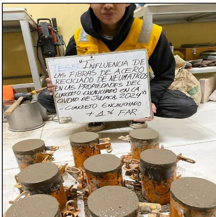
Figura 63. Moldeo de los testigos del concreto encauchado + 1.0% de FAR.
