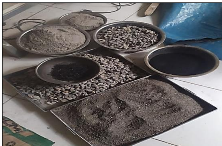
Figura 57. Dosificación de los insumos del concreto
