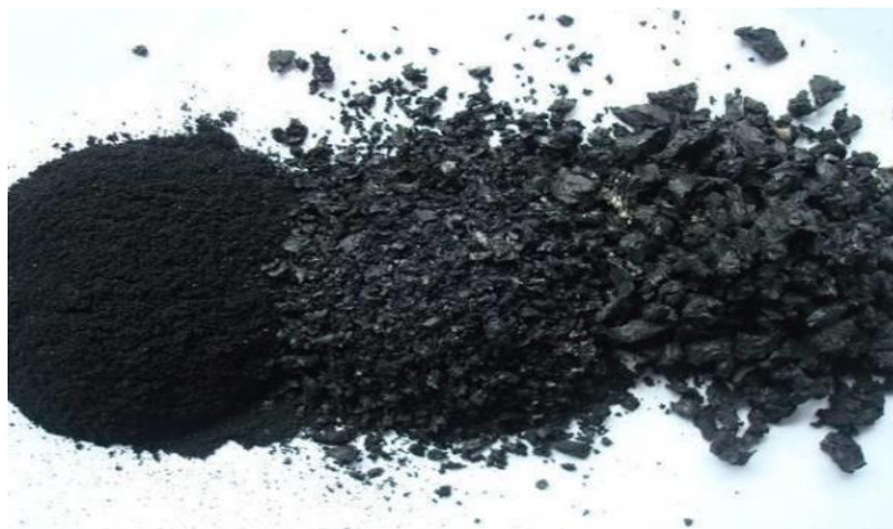
Figura 17. Caucho granulado en distintos tamaños. Tomado de “Comportamiento físico mecánico del concreto hidráulico adicionado con caucho reciclado”, por Cabanillas. 2017, p. 38.
