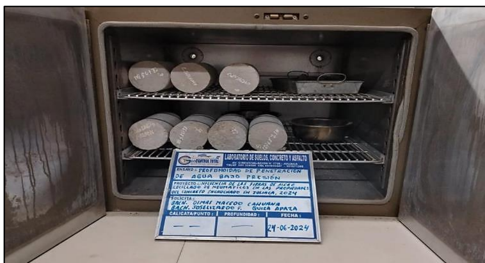
Figura 70. Secado de los testigos de concreto, designados para el ensayo de permeabilidad.
