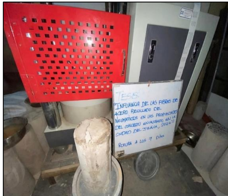
Figura 65. Rotura de los testigos de concreto, para la resistencia a Compresión.
