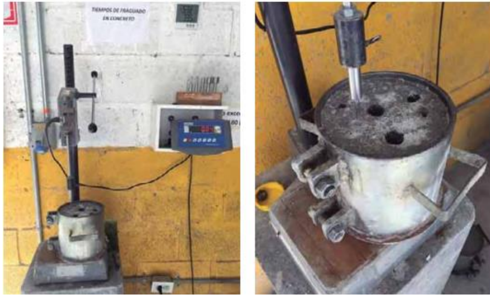
Figura 11. Equipo digital para medir el tiempo de fraguado del concreto. Tomado de “El concreto fundamentos y nuevas tecnologías”, por Matallana, 2019, p. 114.
