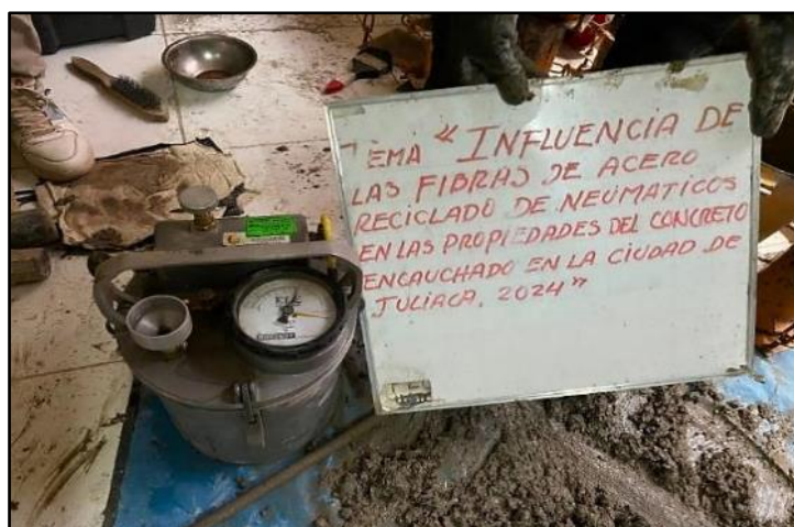
Figura 61. Medición del contenido de aire del concreto.
