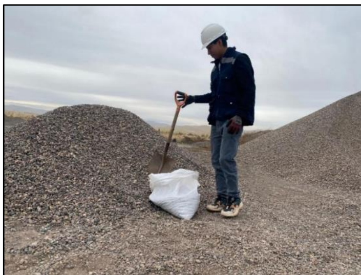
Figura 35. Obtención de Arena Gruesa de la Planta Chancadora (JESERVI SAC)
