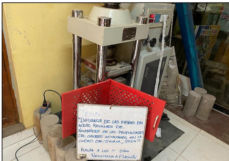
Figura 69. Rotura de concreto de sección tipo Viga, para determinar la Resistencia a flexión del concreto.
