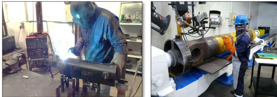
Figura 8. *Proceso de unión de piezas por soldadura.*
