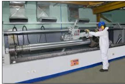
Figura 10. *Bruñido y pulido de cilindros.*
