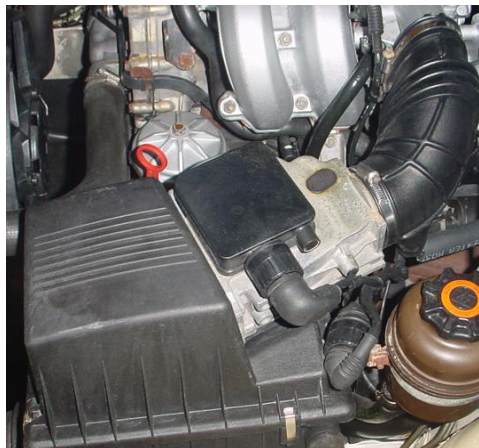
Figura 28. Ubicación del sensor VAF Tomada de Velocidadmaxima.com
