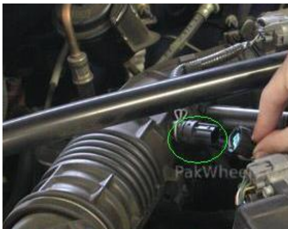
Figura 31. Ubicación del sensor IAT Tomada de Jaimemotordisel.blogspot.com
