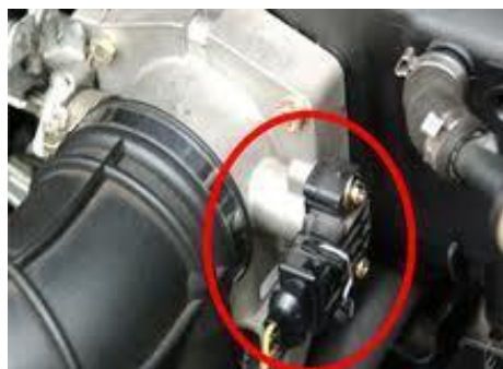
Figura 39. Ubicación del sensor TPS Tomada de Ehmotor.com
