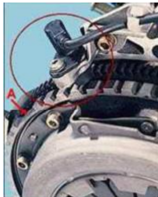
Figura 21. Posición general del sensor CKP Tomada de Renntech.org
