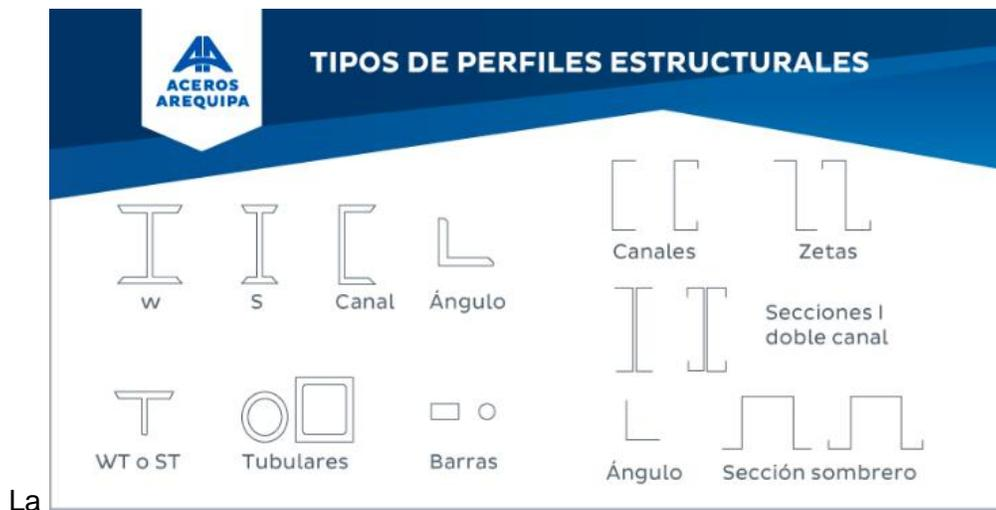
La Figura muestra una variedad de perfiles o secciones transversales de aceros estructurales que, dependiendo del perfil con el que se trabaje, tienen la capacidad de soportar cargas y tipos específicos. Los siguientes son los más utilizados:
