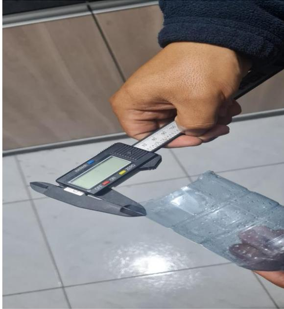
Figura 34. Espesor de botella PET medido con un calibrador.
