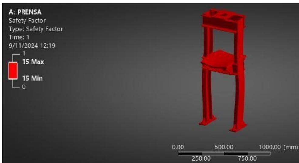
Figura 56. Factor de seguridad de la estructura.
