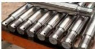
El acero AISI / SAE 1018 - 1020 se utiliza en ejes, cadenas, remaches, tornillos, pernos, sujetadores, engranajes, piñones, piezas de maquinaria, pasadores de baja resistencia, prensas y levas.
