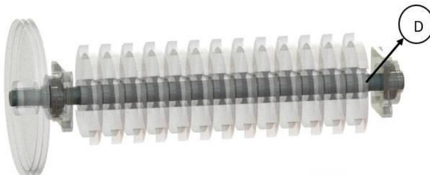
Figura 36. Isométrico eje trituradora.
