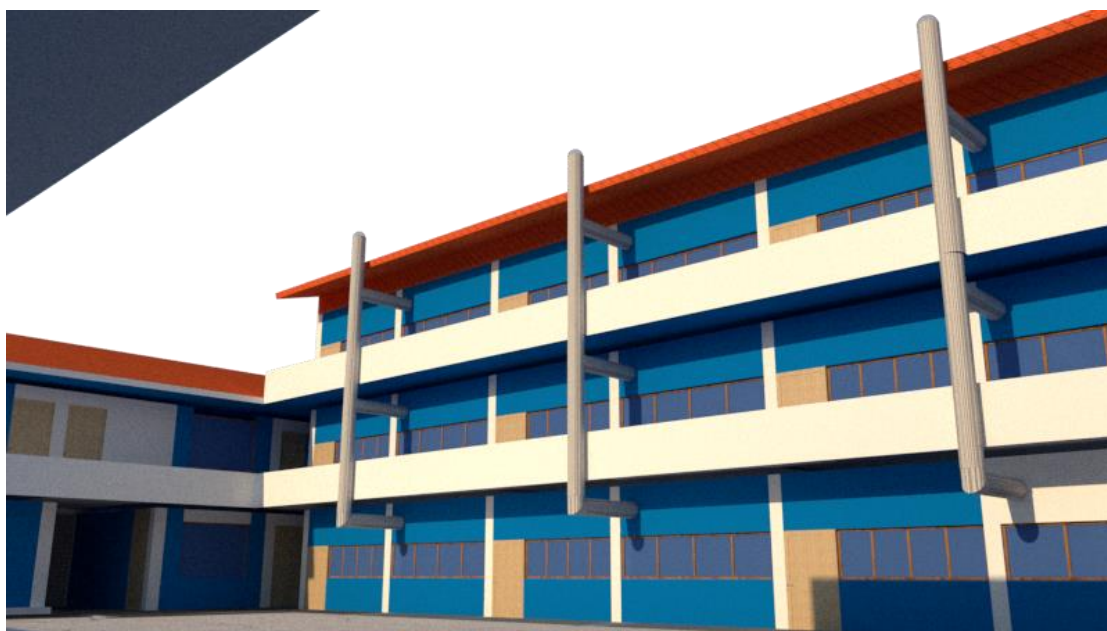
Gráfico 39: Sistema de tubos de luz compartidos para el pabellón B de la I.E.
