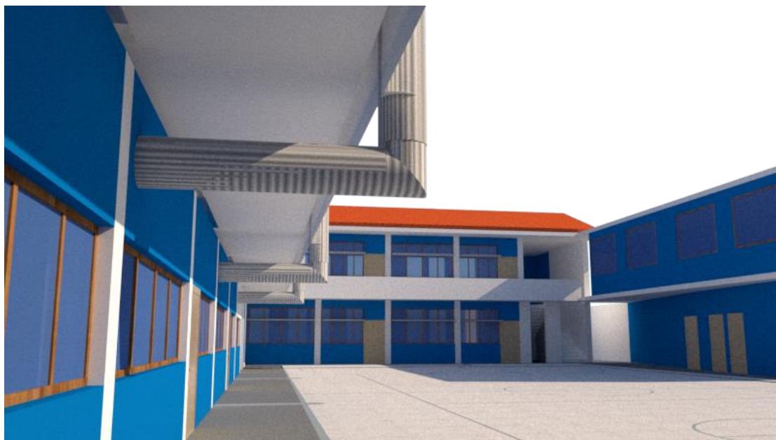
Gráfico 41: Sistema de estantes de luz para el pabellón C de la I.E.
