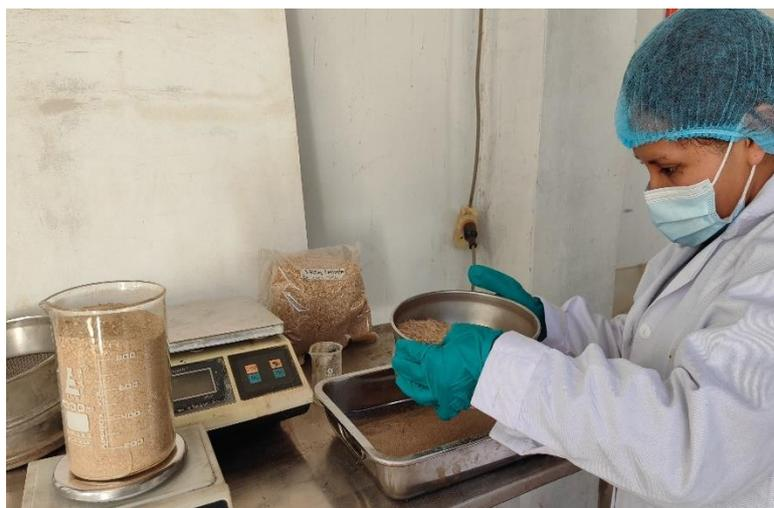
**Figura 15 Tamizado del exoesqueleto**
