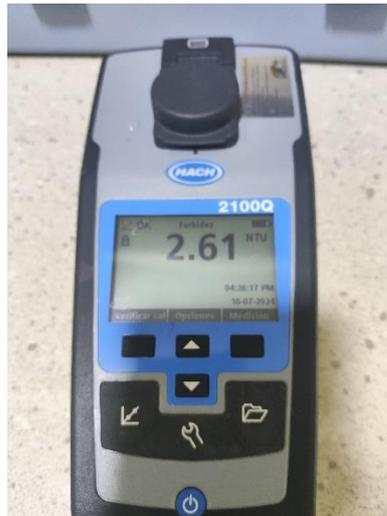
**Figura 26 Resultado del turbidímetro**
