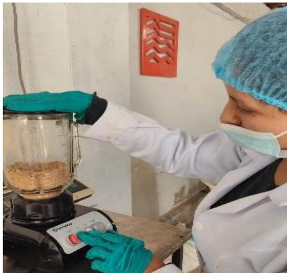
**Figura 14 Trituración del exoesqueleto**
