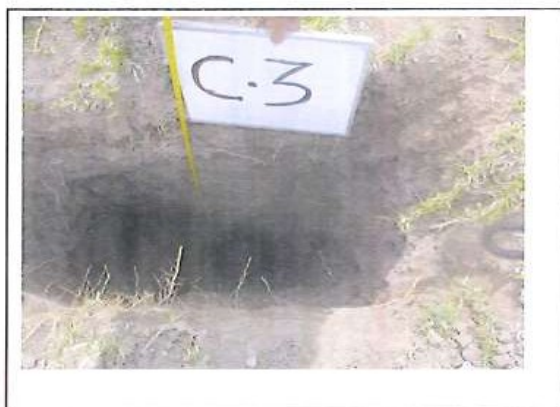
FOTO. 11.- PROFUNDIDAD DE EXCAVACION, 3.00 mts C-3, I.E.I. N° 30244 – JUANA GUERRA CHAVEZ
