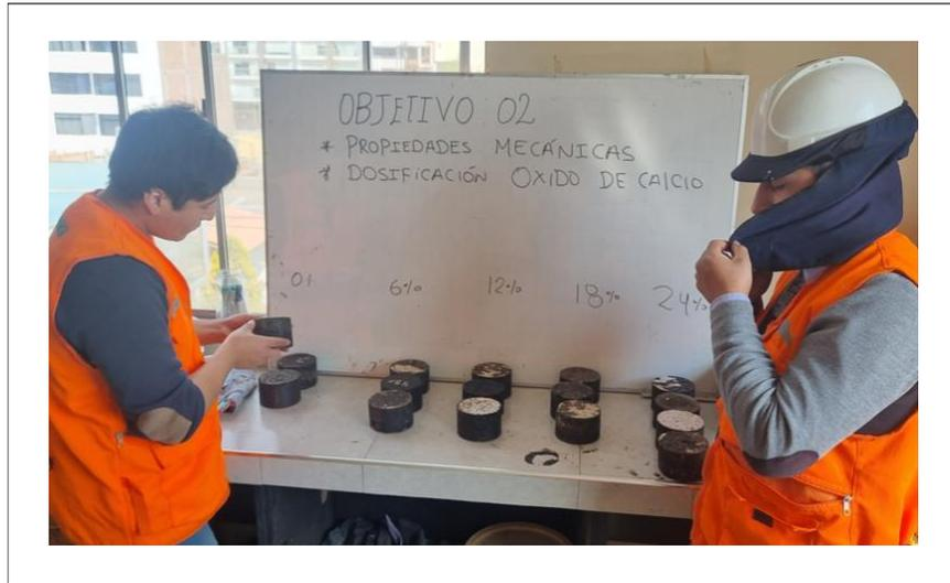
Anexo N° 37. Se preparó un grupo de briquetas de la mezcla obtenida para un óptimo % de ligante asfáltico para 0% de óxido de calcio.
