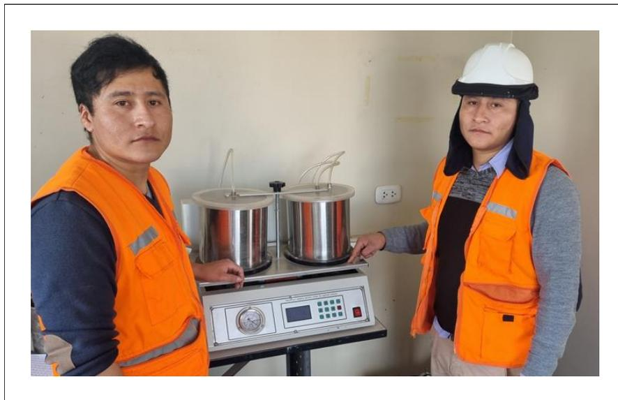
Anexo N° 36. Equipo Rice empleado para la determinación de la gravedad específica teórica máxima de mezclas asfálticas
