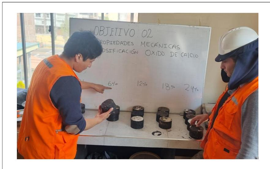
Anexo N° 38. Se preparó un grupo de especímenes de la mezcla obtenida para un óptimo ideal de cemento asfáltico para el 6% de óxido calcio, en función al peso de la mezcla.
