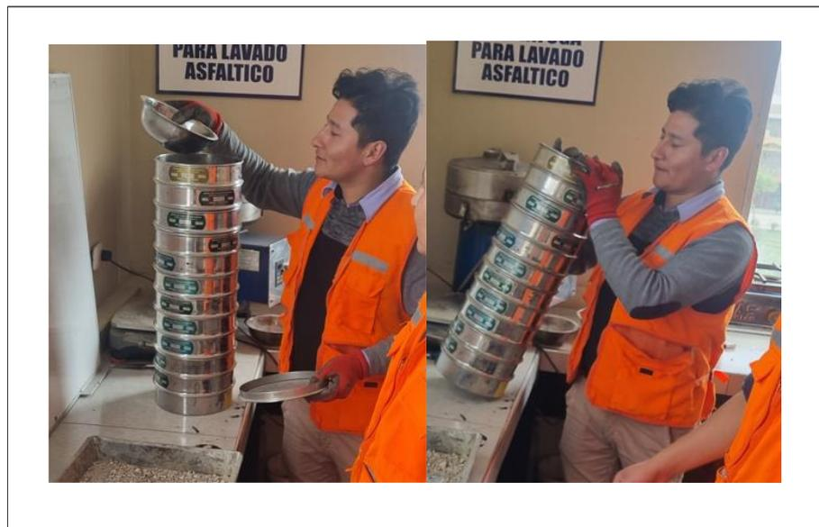
Anexo N° 12. Inicio de la fase de la clasificación arena triturada mediante el tamizado, de igual manera debe controlarse el tiempo adecuado para realizar un tamizado correcto de la muestra.
