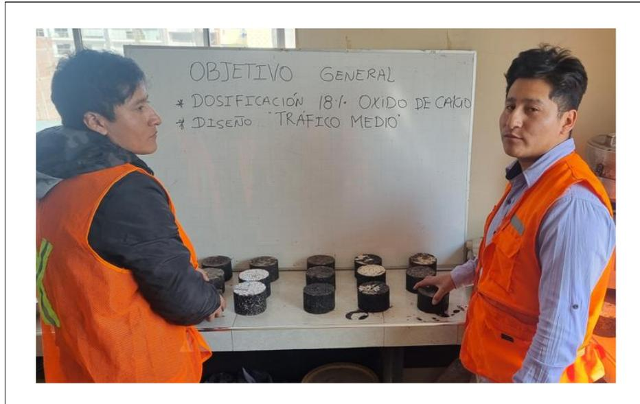
Anexo N° 53: Se adicionará a la mezcla obtenida para un óptimo % de óxido de calcio el cemento asfáltico en 4%, 4.5%, 5%, 5.5%, 6% y 6.5%, realizando el diseño para tráfico medio.
