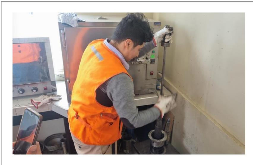
Anexo N° 22. Compactado de las briquetas mediante el uso del martillo Marshall, aplicando 75 golpes por cada lado de la cara, según los requisitos de la normatividad MTC E 504.
