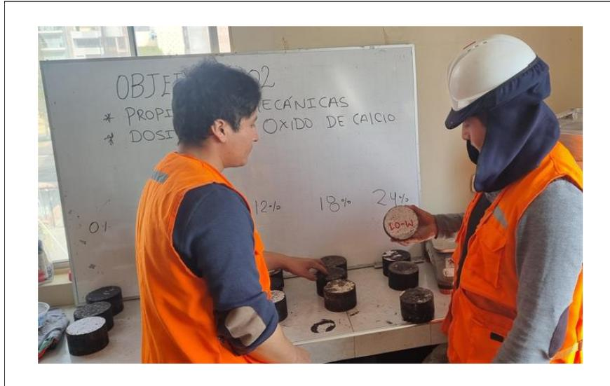
Anexo N° 41. Se preparó un grupo de briquetas de la mezcla obtenida para un óptimo contenido de ligante asfáltico, para el 24% de óxido de calcio añadida al AG, en función al peso de la mezcla.
