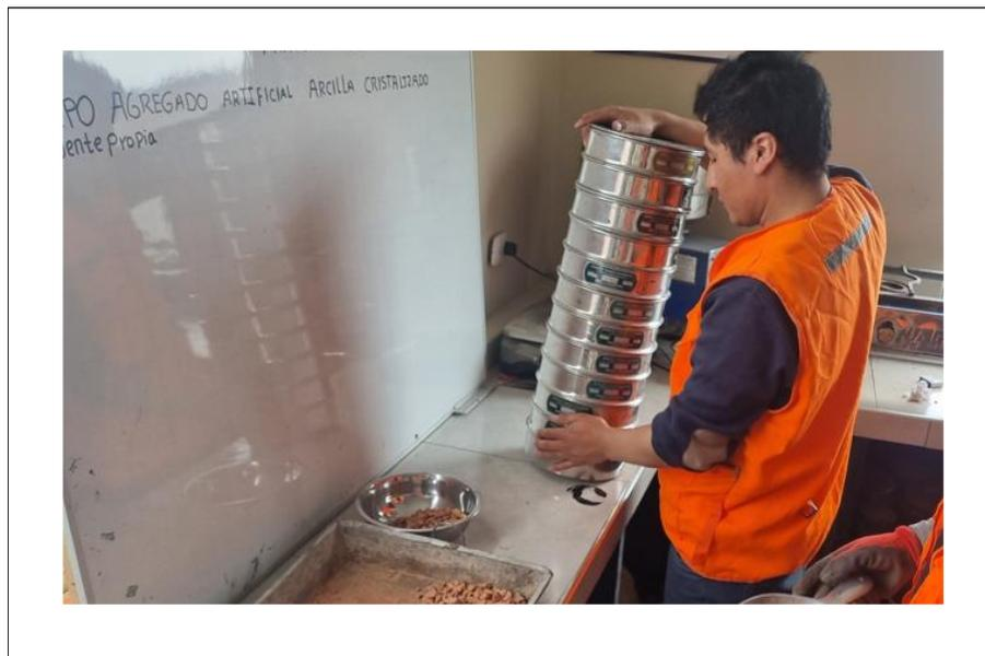
Anexo N°8. Comienzo de procedimiento de clasificación por tamizado de agregado artificial de arcilla, se debe establecer un tiempo adecuado para llevar a cabo el tamizado correcto de la muestra.
