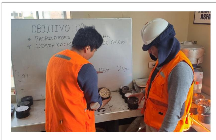
Anexo N° 40. Se preparó un grupo de briquetas de la mezcla bituminosa obtenida para un óptimo % de cemento asfáltico el 18% de óxido de calcio, de acuerdo con el peso de la mezcla.
