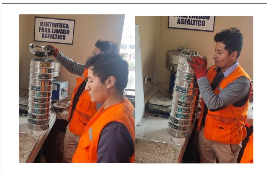
Anexo N° 10. Inicio de la clasificación por tamizado del AF correspondiente a la arena natural, es necesario estimar el tiempo adecuado para efectuar un tamizado correcto de la muestra.
