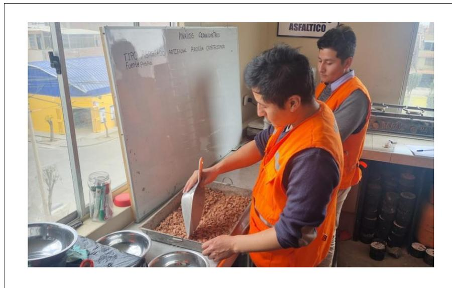
Anexo N° 6. Muestra de agregado artificial arcilla para caracterización granulométrica.
