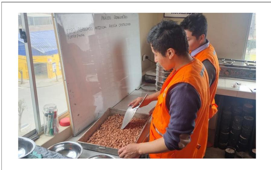
Anexo N° 4. Muestra de agregado artificial de arcilla resultante.
