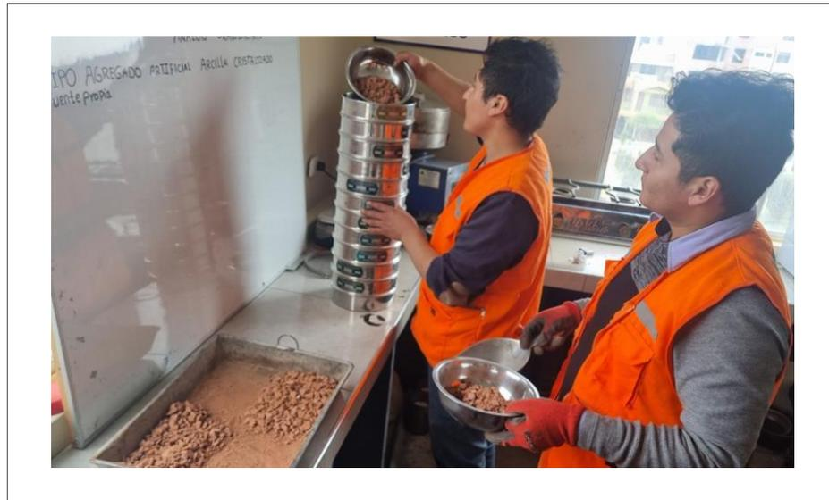
Anexo N° 7. Peso de muestra correspondiente a 3000 gramos de agregado artificial de arcilla, según las especificaciones MTC E 204 este es el peso requerido para realizar un análisis granulométrico adecuado.
