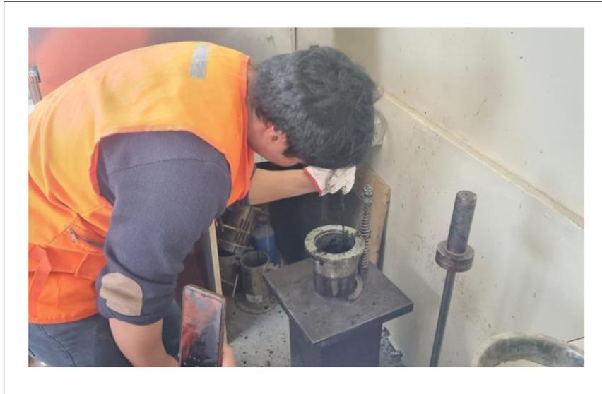
Anexo N° 21. Chuseo manual de mezcla utilizando una varilla de 3/8" introduciendo al centro y a lo largo del diámetro de la mezcla con fin de eliminar la presencia de aire.
