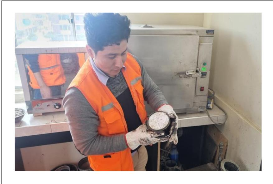
Anexo N° 23. Briquetas obtenidas correspondientes al diseño de la mezcla asfáltica en calientes propuestas en estudio, la cual serán sometidas a la rotura según los porcentajes de cemento asfáltico empleados.
