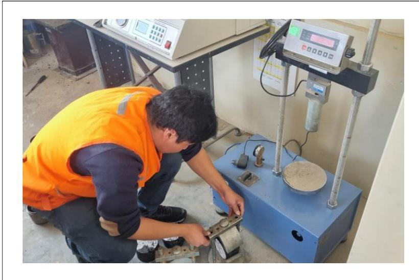
Anexo N° 27. Colocación de briquetas obtenidas de la mezcla bituminosa en la mordaza.
