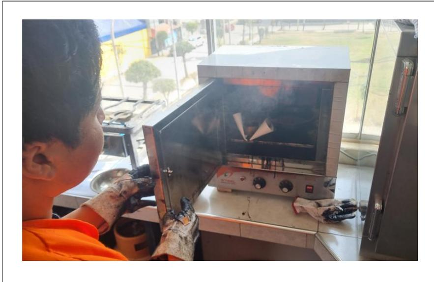
Anexo N° 17. Ligante asfáltico de PEN 85-100, el cual tuvo que mantenerse a altas temperaturas en el horno para elaborar la mezcla asfáltica en caliente.
