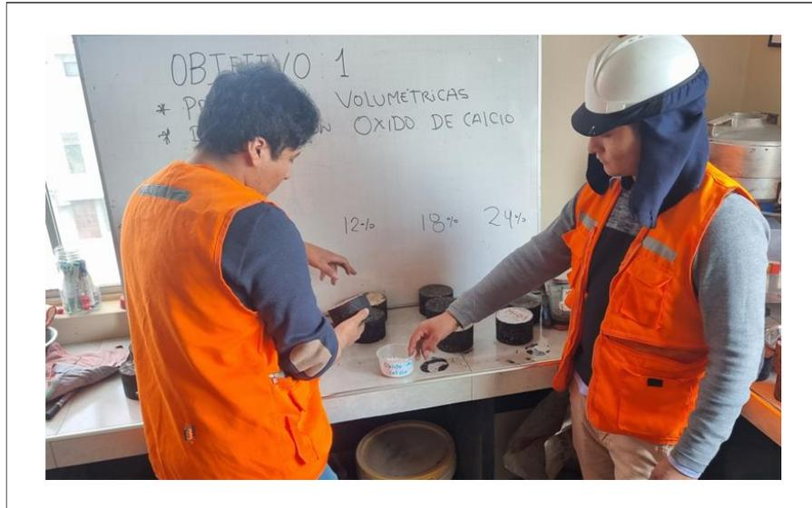
Anexo N° 31. Se adicionará a la mezcla obtenida para un óptimo % de ligante asfáltico para el 12% de óxido calcio añadida al AG, con referencia al peso de la mezcla.
