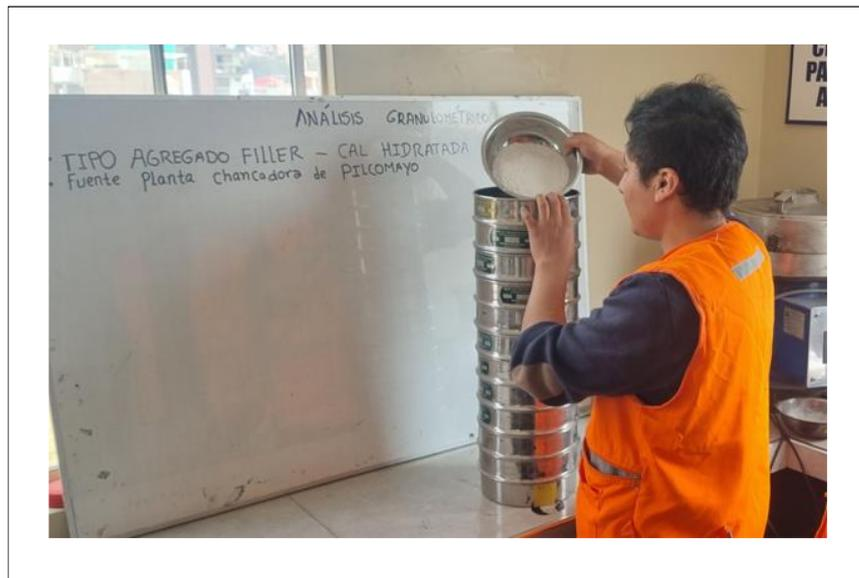
Anexo N° 14. Inicio de proceso de tamizado de la cal hidratada como filler
