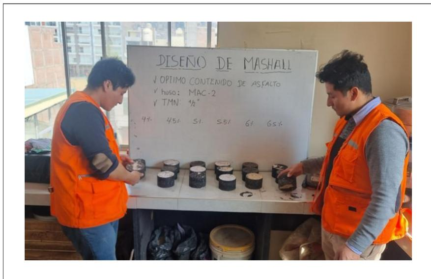
Anexo N° 24. Grupo de especímenes de briquetas de la mezcla bituminosa en caliente obtenidas al 4%, 4.5%, 5%, 5.5%, 6% y 6.5% de cemento asfáltico, las cuales son preparadas para los siguientes ensayos.
