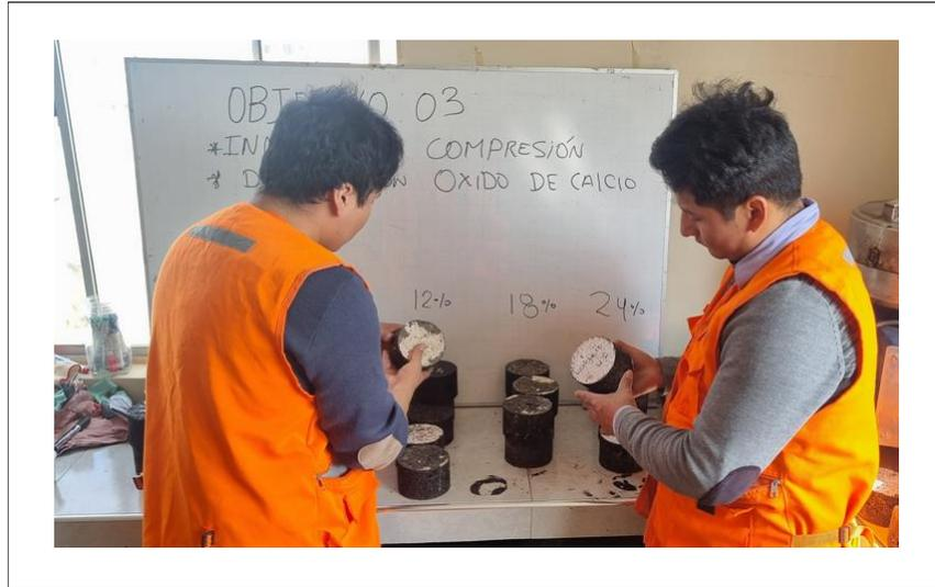
Anexo N° 45. Se elaboraron dos nuevos grupos de briquetas por cada % de óxido de calcio, con medidas de las probetas 4 pulgadas de diámetro y de altura, al emplear 12% de óxido de calcio.
