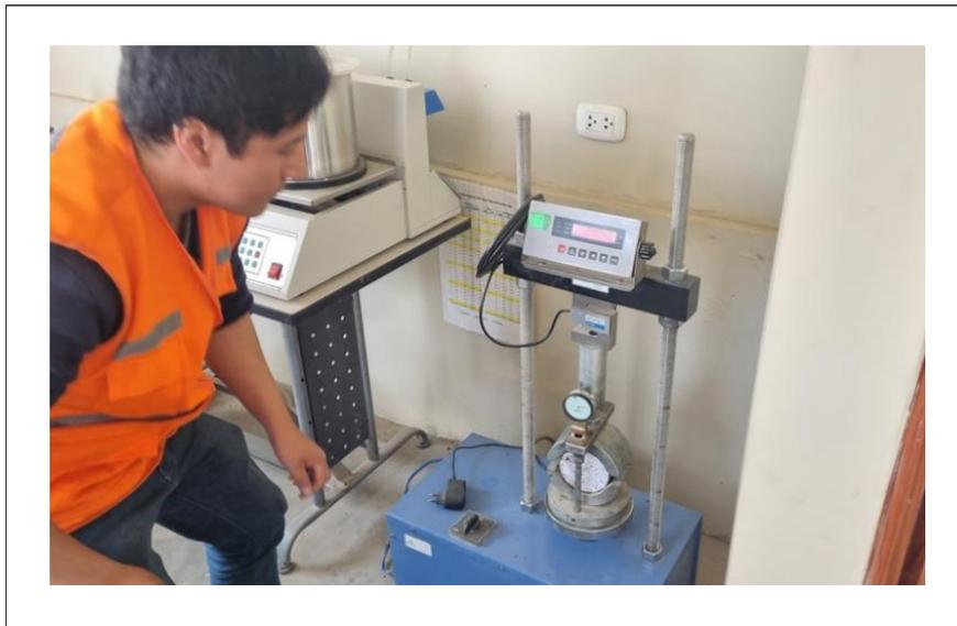
Anexo N° 42. Registro de lectura de la estabilidad y el flujo de las briquetas utilizando el aparato de Marshall tras la adición de óxido de calcio en AG.
