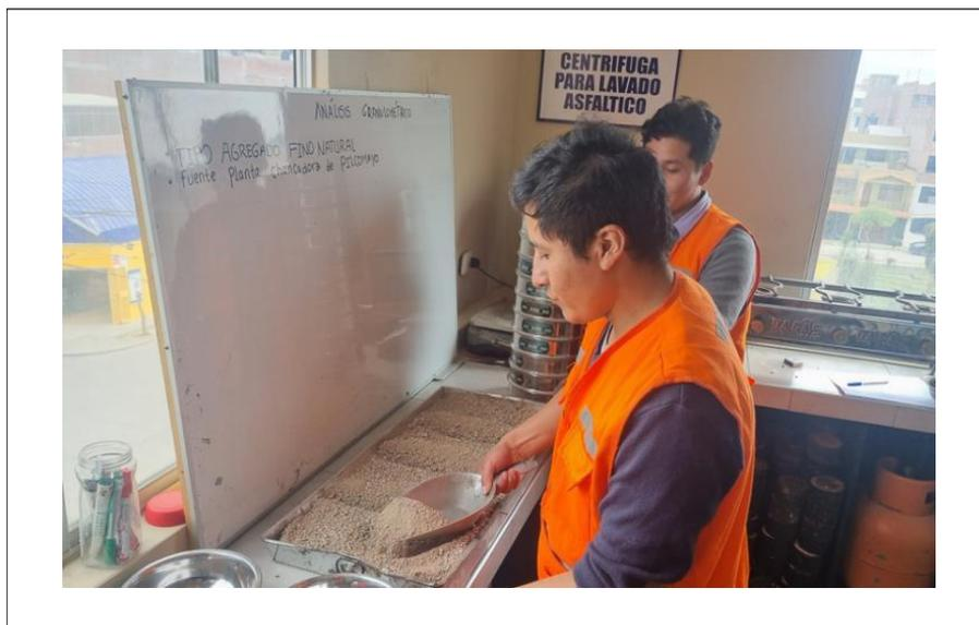
Anexo N° 9. Peso total de la muestra de 1500 gramos del árido fino, arena de origen natural, según la normativa MTC E 204 este es el peso estipulado para realizar correctamente el análisis granulométrico del material fino.
