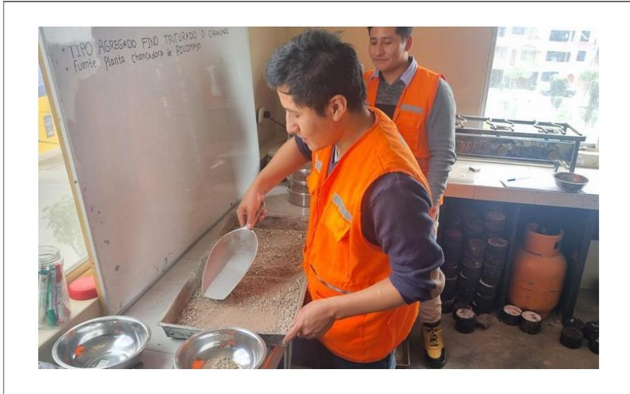
Anexo N° 11. Peso de muestra de 1500 gramos de arena triturada proveniente de cantera, de acuerdo con la norma MTC E 204 este el peso indicado para llevar a cabo un correcto análisis granulométrico para arenas.
