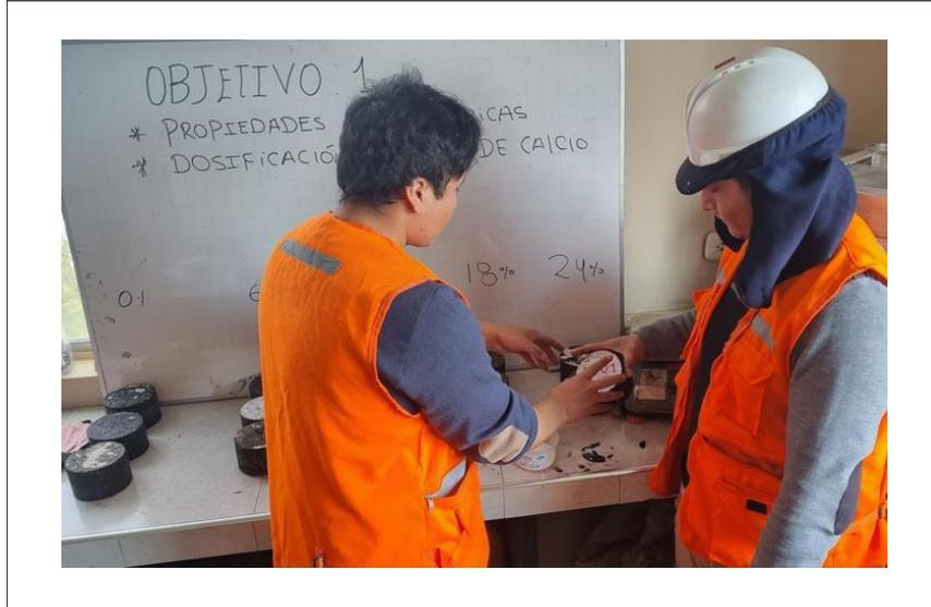
Anexo N° 33. Se adicionará a la mezcla obtenida para un óptimo % de cemento ligante asfáltico para el 24% de óxido calcio incorporada al AG, en proporción al peso de la mezcla.
