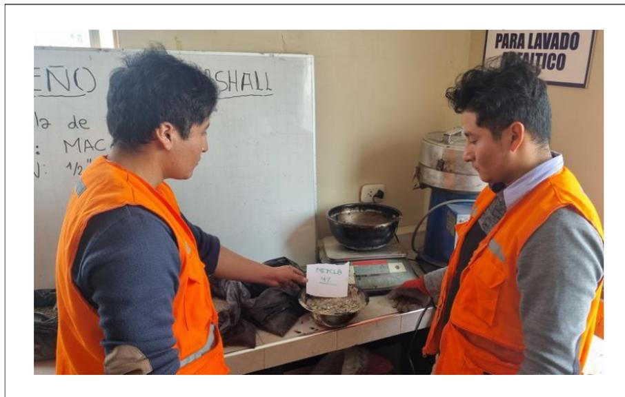
Anexo N° 16. Determinación del Peso total del agregado (AF, AG) de acuerdo con la combinación teórica MAC 02, para que la mezcla total alcance un peso de 1250 gr.
