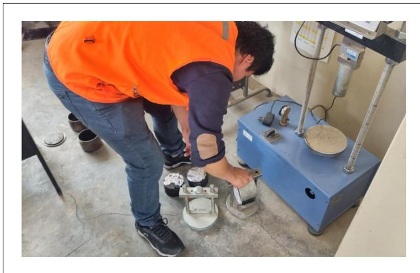
Anexo N° 26. Preparación del dispositivo de la sujeción de la mordaza para efectuar el ensayo de Marshall.
