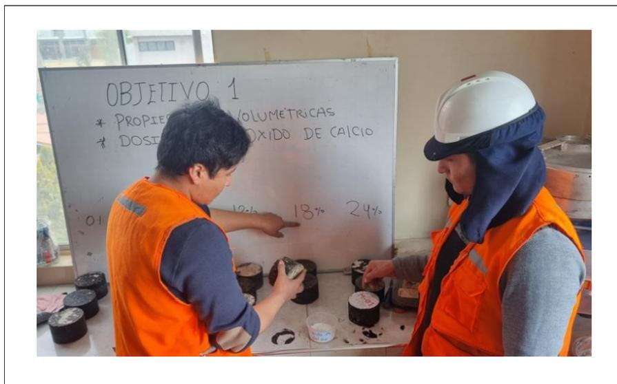
Anexo N° 32. Se adicionará a la mezcla obtenida para un óptimo % de cemento asfáltico para el 18% de óxido de calcio añadida al AG, esto en relación con el peso de la mezcla.
