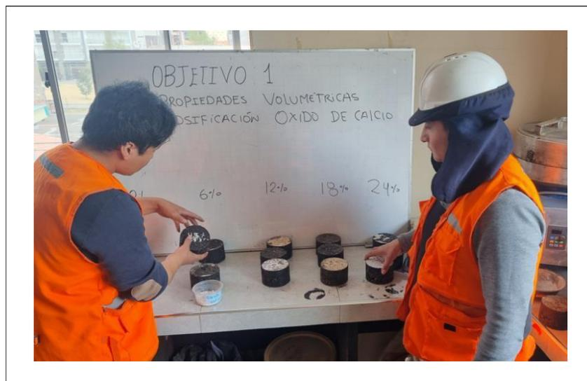
Anexo N° 30. Se adicionará a la mezcla obtenida para un óptimo contenido de ligante asfáltico para el 6% de óxido de calcio adicionada al AG, respecto al peso total de la mezcla.
