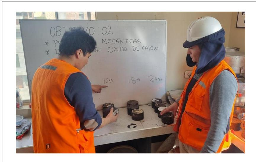
Anexo N° 39. Se preparó un grupo de briquetas de la mezcla obtenida para el óptimo % de ligante asfáltico, para el 12% de óxido de calcio, con relación al peso de la mezcla.
