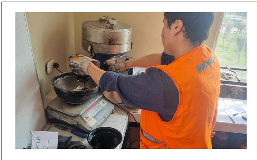
Anexo N° 18. Incorporación del ligante asfáltico de PEN85-100 en la mezcla de agregados.
