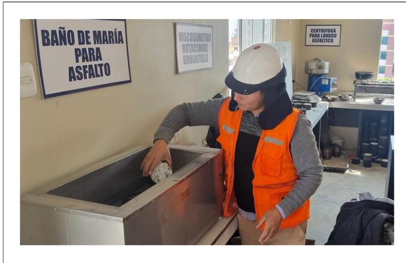
Anexo N° 25. Exposición de las muestras a un baño María por un lapso de treinta minutos, para acondicionar los especímenes y posteriormente proceder con el ensayo de estabilidad Marshall.
