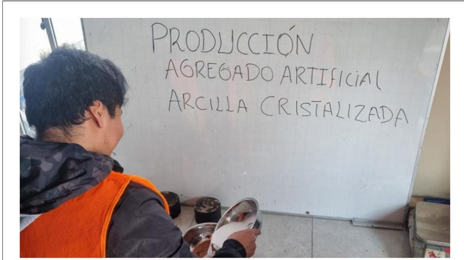
Anexo N° 1. Producción de agregado artificial de arcilla con agua con óxido de calcio
