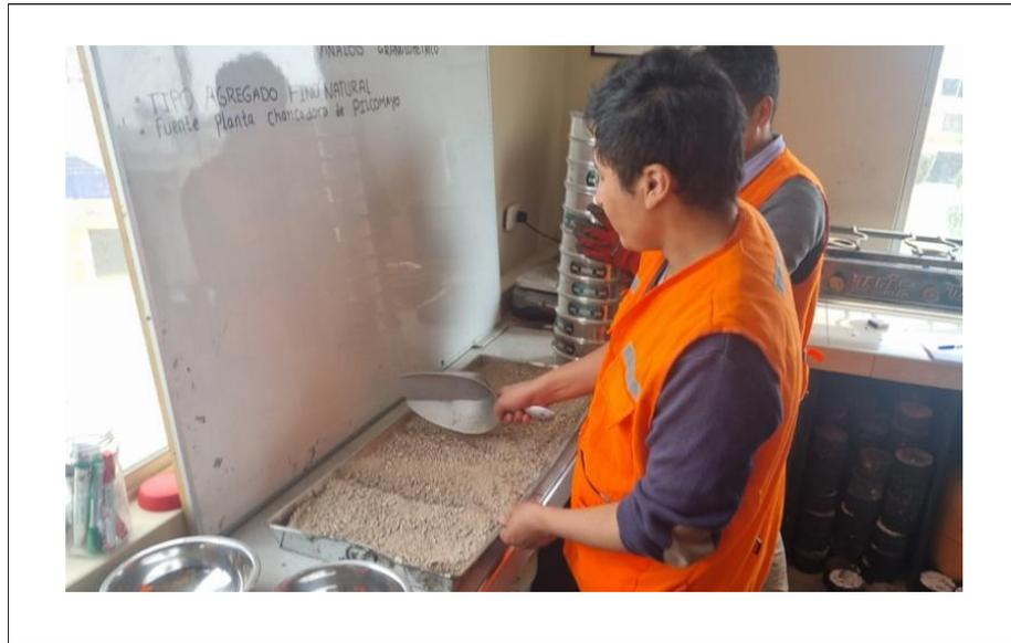
Anexo N° 5. Muestras de agregados: arena natural zarandeada y arena triturada extraídas de la cantera de Pilcomayo.
