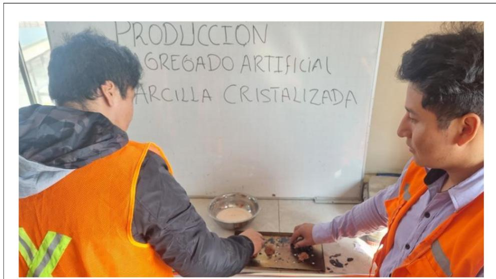
Anexo N° 2. Tras la mezcla de la arcilla triturada con el óxido de calcio se forman masas de arcilla y las bolitas resultantes se colocan en una bandeja para ser llevadas al horno.
