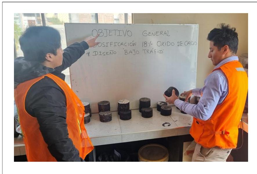
Anexo N° 52. Se adicionará a la mezcla obtenida para un óptimo porcentaje de óxido de calcio el cemento asfáltico en 4%, 4.5%, 5%, 5.5%, 6% y 6.5%, realizando el diseño para tráfico bajo.
