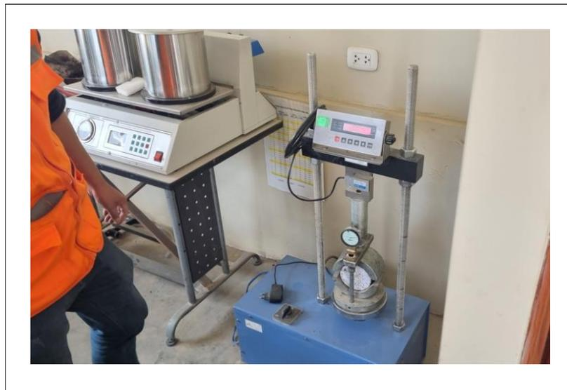
Anexo N° 28. Registro de la lectura sobre la estabilidad y el flujo empleando el aparato de Marshall de las briquetas de mezcla asfáltica en caliente. Para poder obtener las lecturas de los diales de manera exacta fue documentado el ensayo mediante una grabación.
