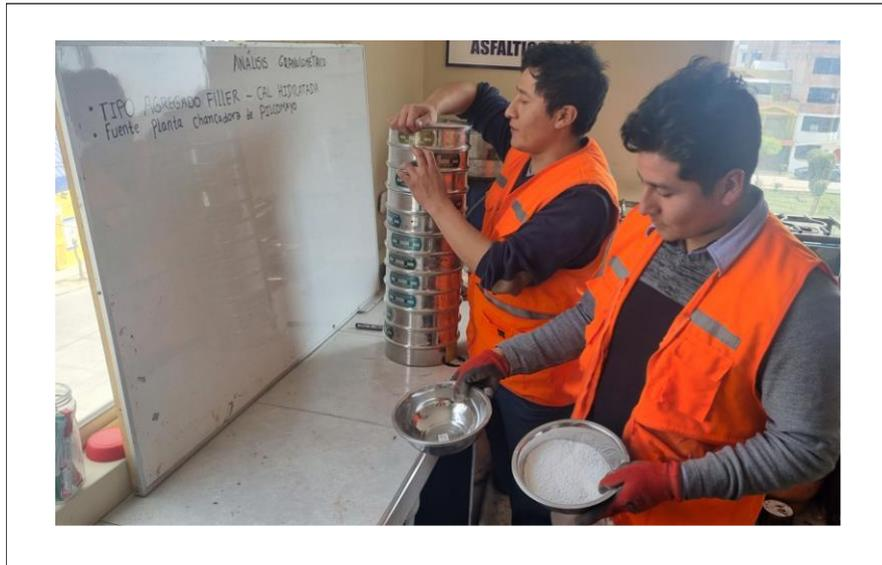
Anexo N° 13. Muestra de cal hidratada para el análisis granulométrico.
