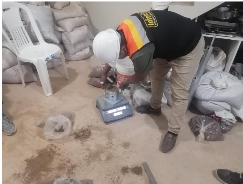
Imagen 2: Toma de masa de material compactado - Ensayo Proctor Modificado
