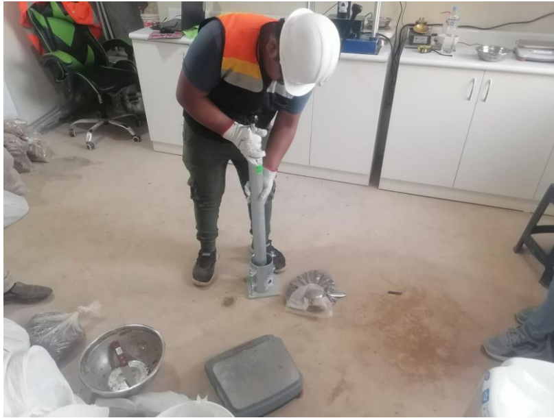
Imagen 1: Compactación de material en molde - Ensayo Proctor Modificado
