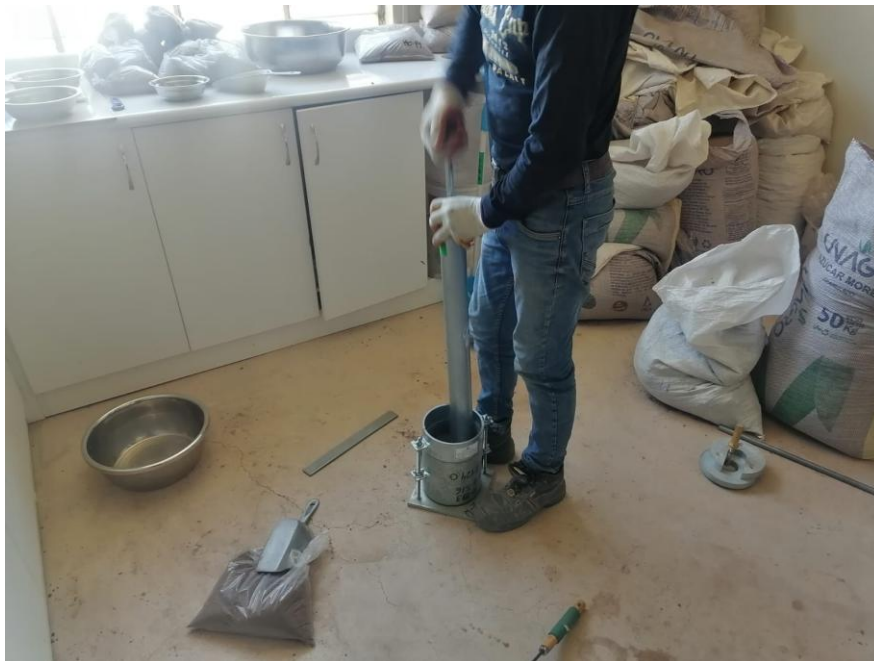
Imagen 4: Compactación de material con martillo Proctor - Ensayo Proctor Modificado
