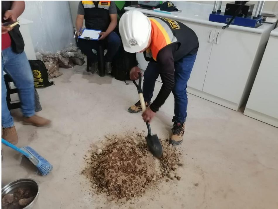
Imagen 7: Homogenización de material para ensayo - Ensayo Proctor Modificado
