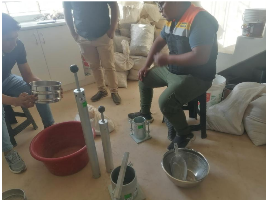
Imagen 6: Selección de equipos y herramientas para ensayo - Ensayo Proctor Modificado
