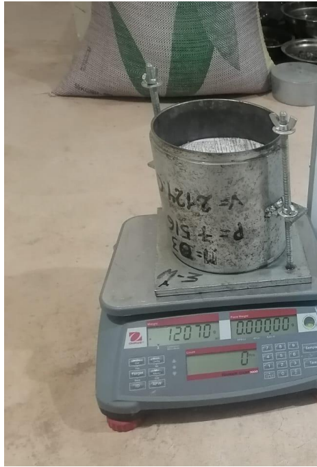
Imagen 9: Toma de masa de material compactado - Ensayo CBR
