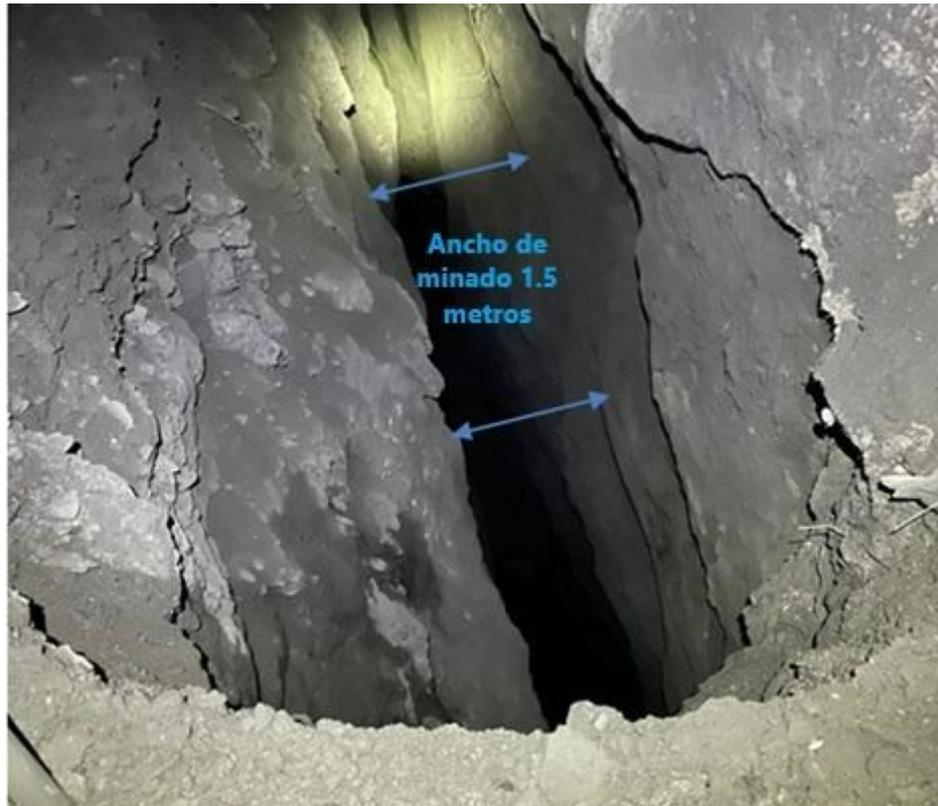
*Figura 15. Análisis de optimización sobre rotura del tajeo 6432 – 1, nivel 3990 en la unidad minera Uchucchacua*
