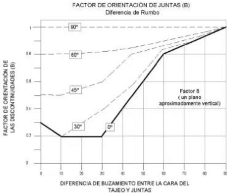
**Figura 5. Factor Orientación de Juntas, B**
