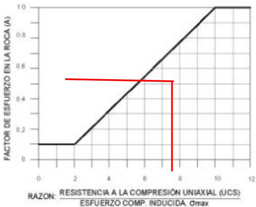
*Figura 17. Factor de esfuerzo en la roca, A
