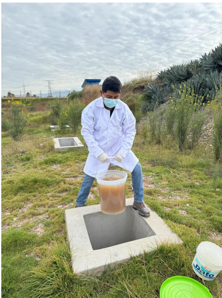
Figura 10. Toma de muestra de agua residual domestica ingreso a la poza de oxidación.
