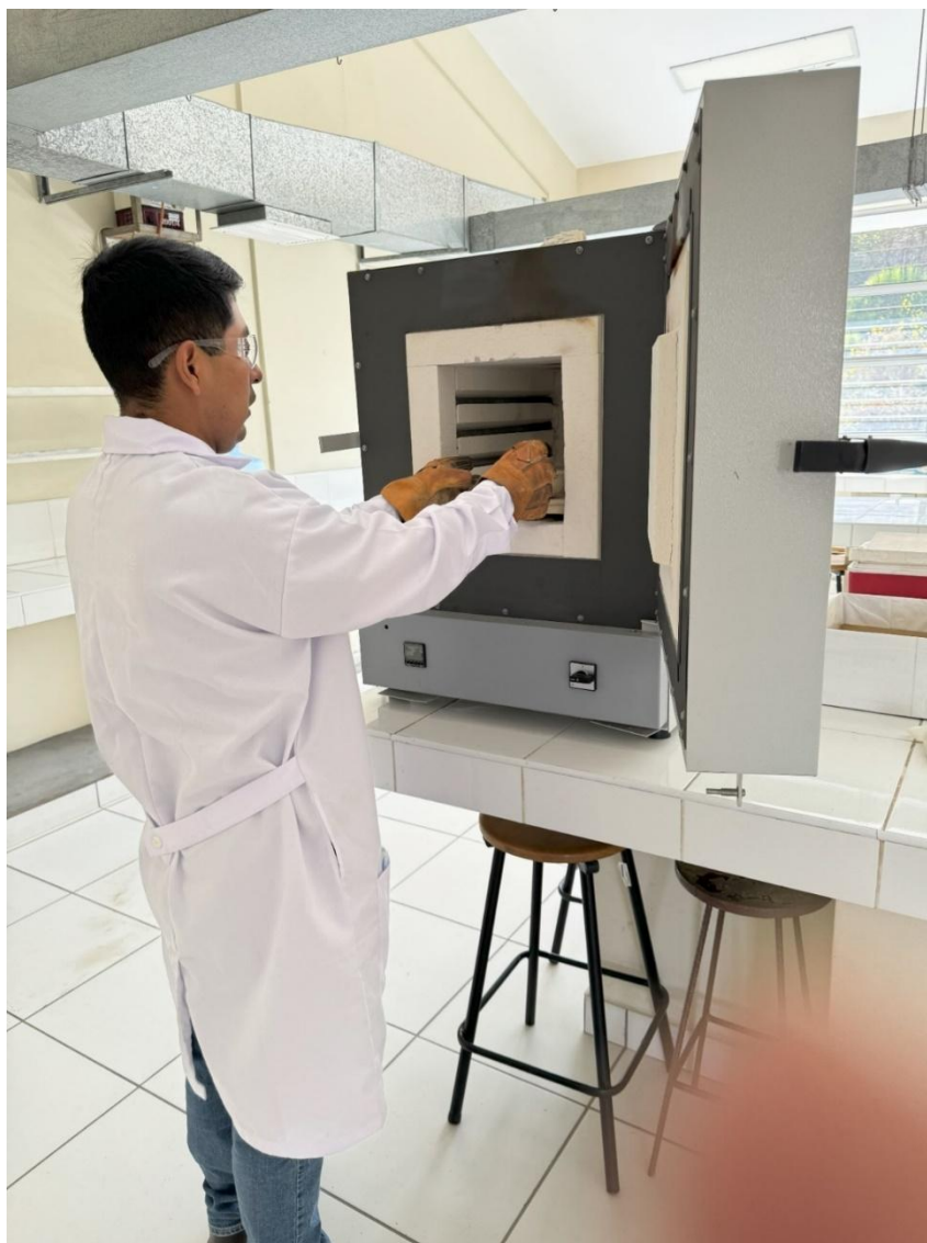
Figura 8. Traslado a la mufla por 8 horas a 900°C para su activación y enfriado posterior
