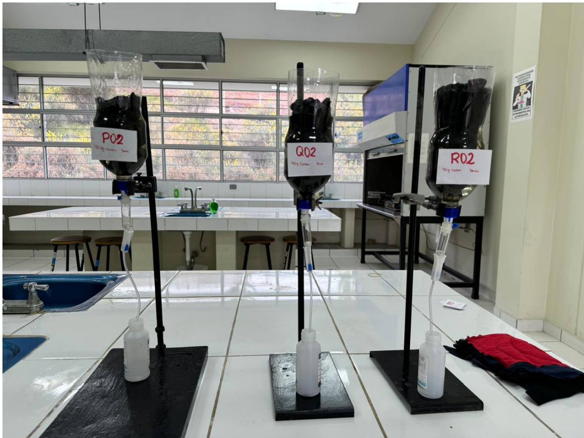
Figura 12. Triplicado de tratamiento con 40g de carbón activado en un tiempo de 5 min. Nota. Fotografía propia
