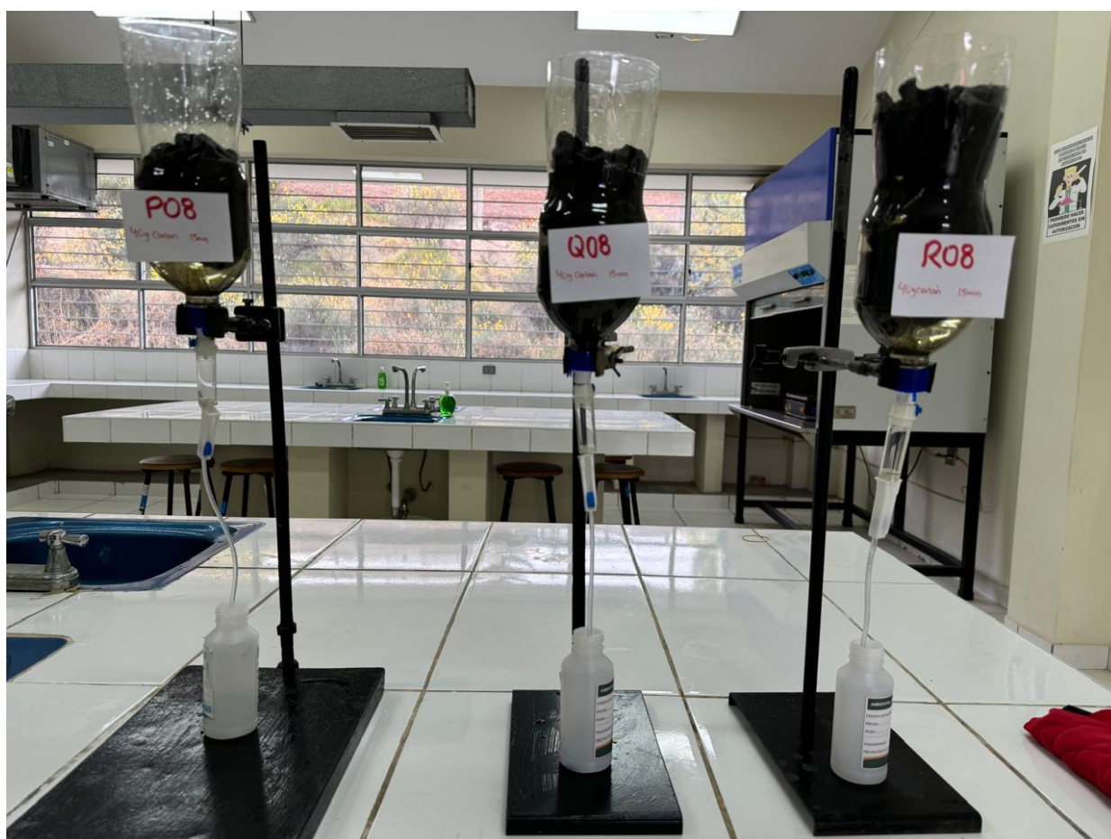
Figura 18. Triplicado de tratamiento con 40g de carbón activado en un tiempo de 15 min
