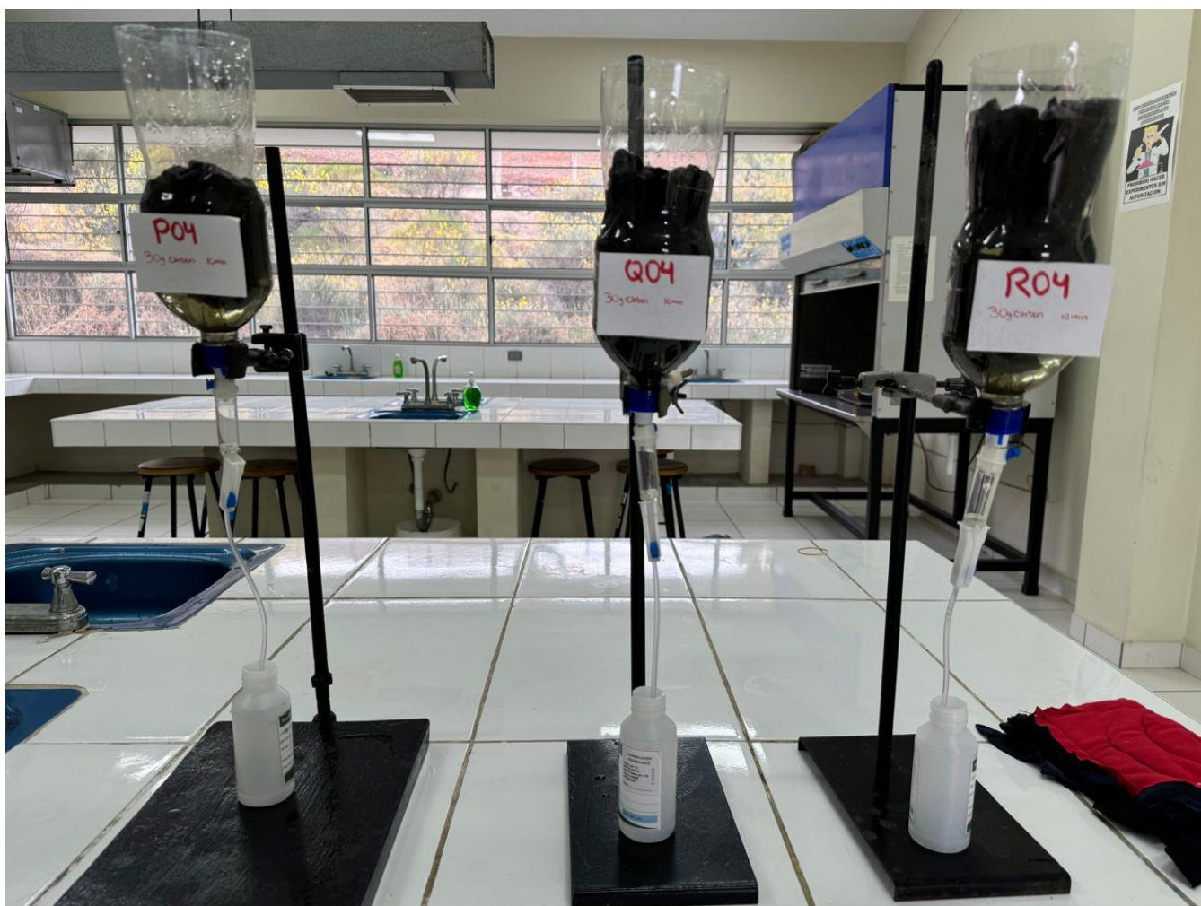
Figura 14. Triplicado de tratamiento con 30g de carbón activado en un tiempo de 10 min
