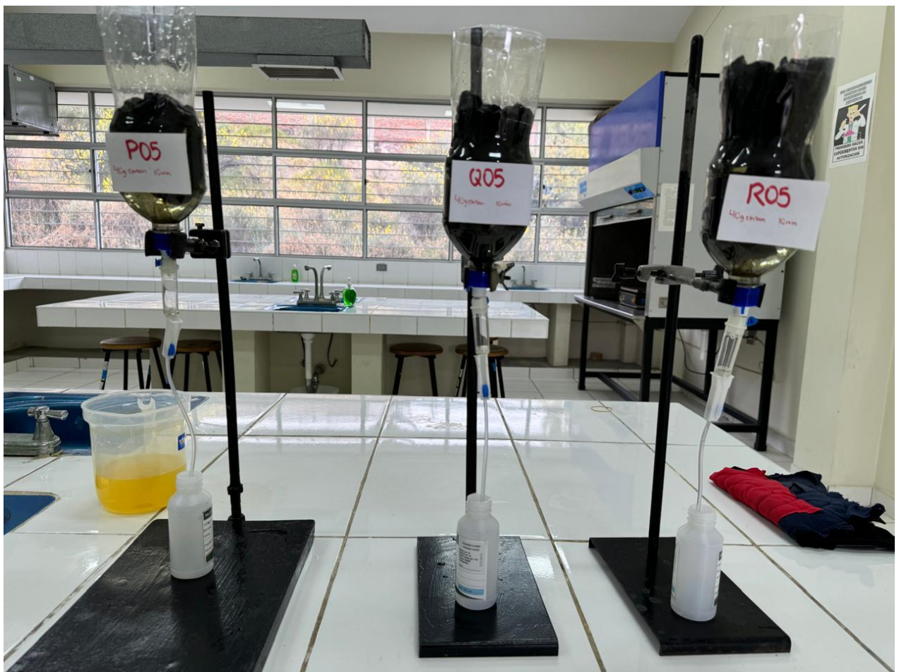
Figura 15. Triplicado de tratamiento con 40g de carbón activado en un tiempo de 10 min
