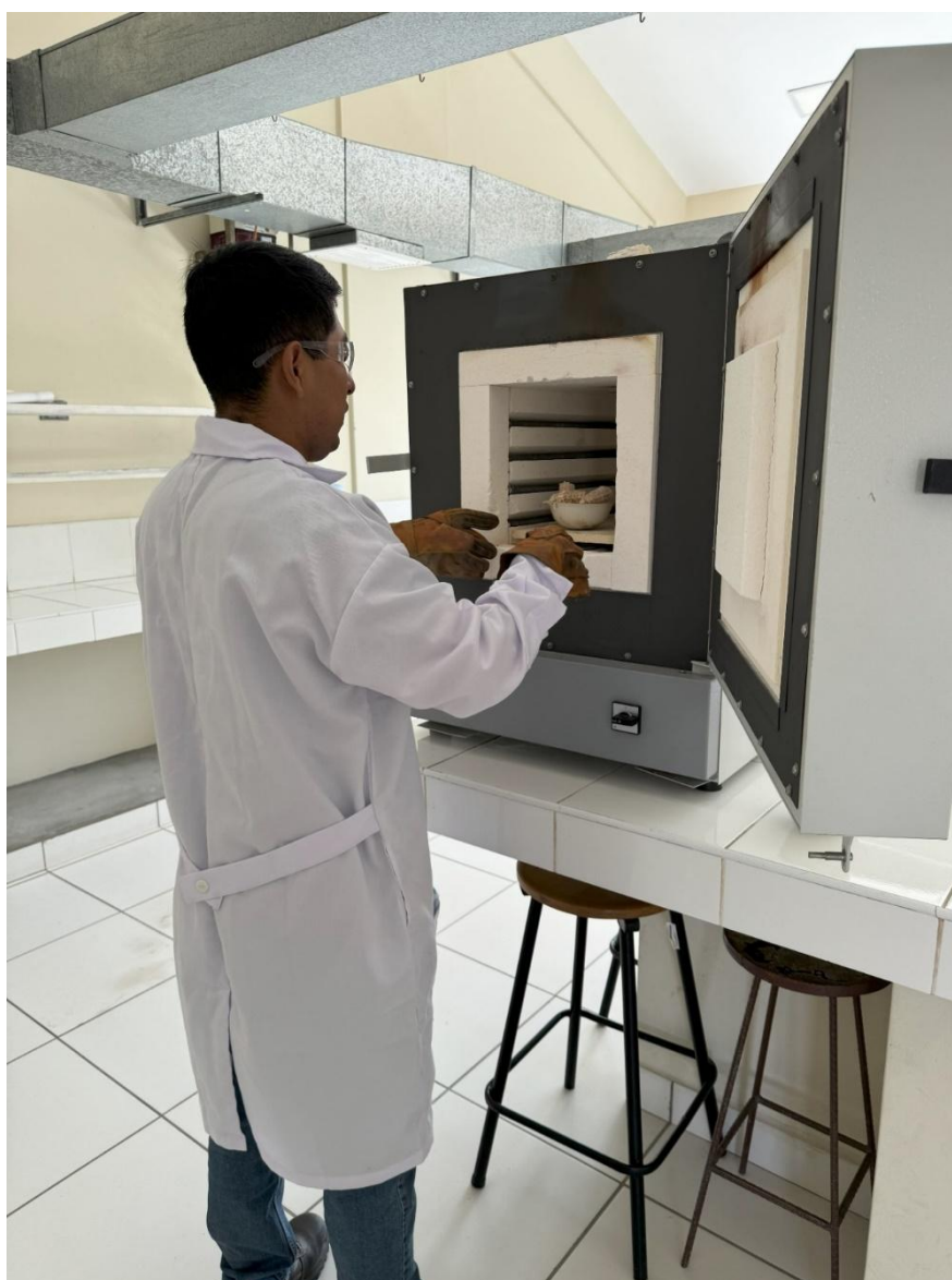
Figura 6. Traslado a la mufla a 500 °C para su combustión y carbonización. Nota. Fotografía propia
