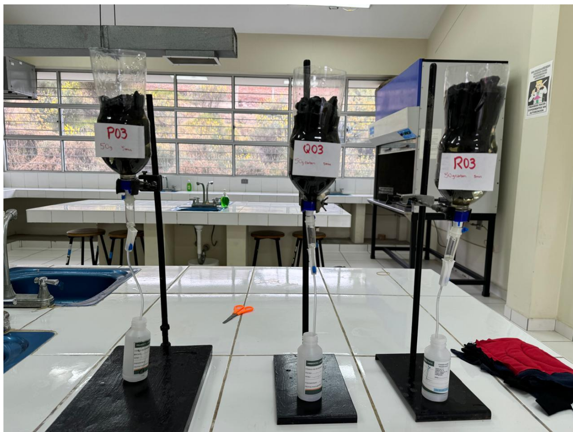
Figura 13. Triplicado de tratamiento con 50g de carbón activado en un tiempo de 5 min Nota. Fotografía propia
