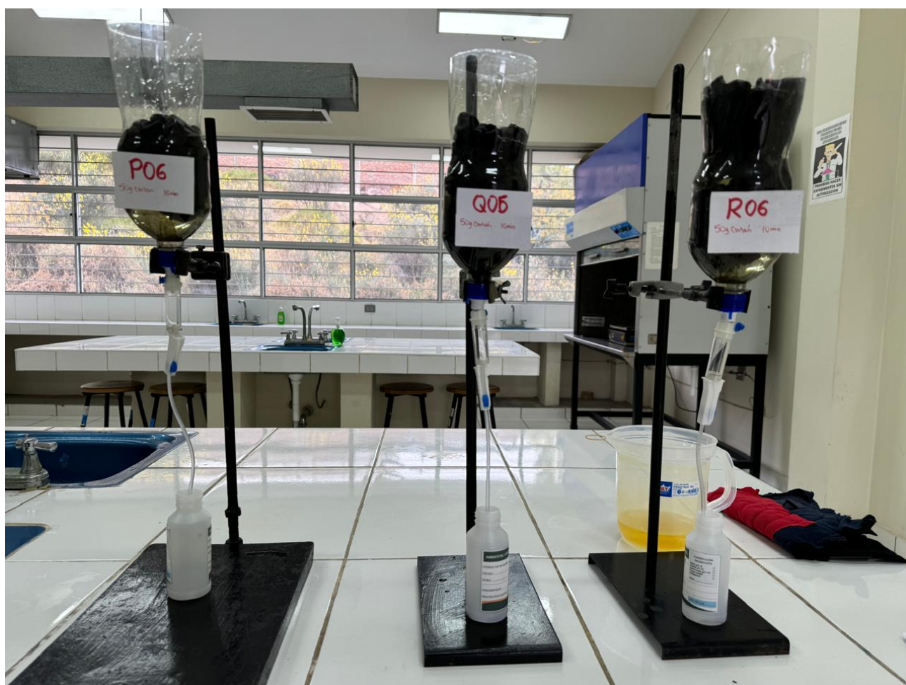
Figura 16. Triplicado de tratamiento con 50g de carbón activado en un tiempo de 10 min Nota. Fotografía propia
