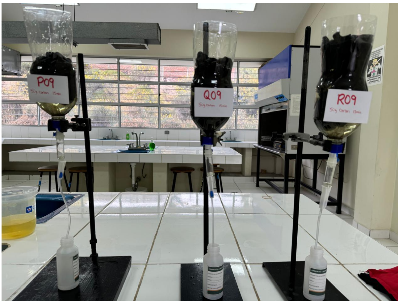
Figura 19. Triplicado de tratamiento con 50g de carbón activado en un tiempo de 15 min
