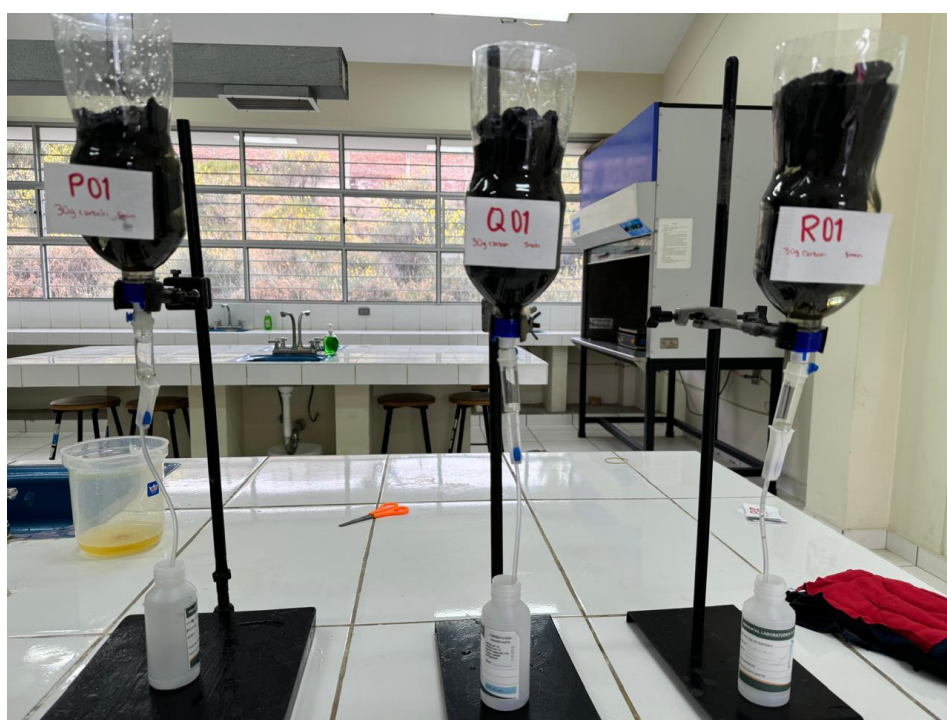
Figura 11. Triplicado de tratamiento con 30 g de carbón activado en un tiempo de 5 min.
