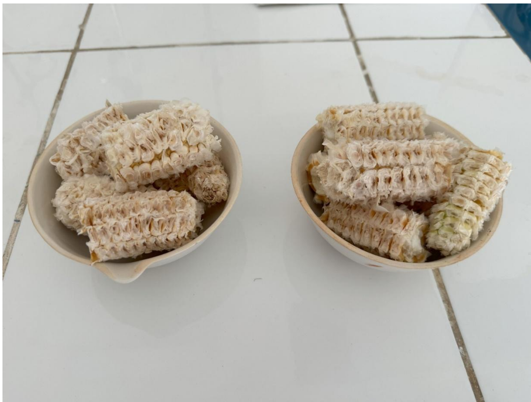
Figura 5. Preparación carbón activado con 4.5 kg de tusa de maíz secado a temperatura ambiente Nota. Fotografía propia
