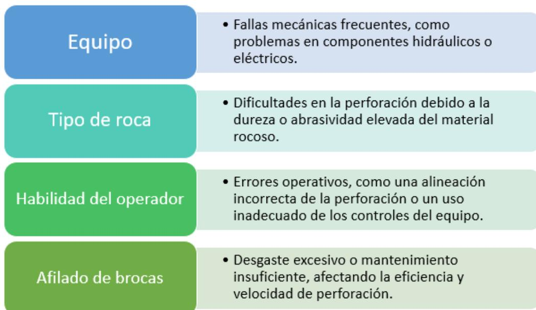
**Figura 9. Estado situacional - Fallas operativas del equipo de perforación del Subnivel 75-2 este, Unidad Minera San Cristóbal**
