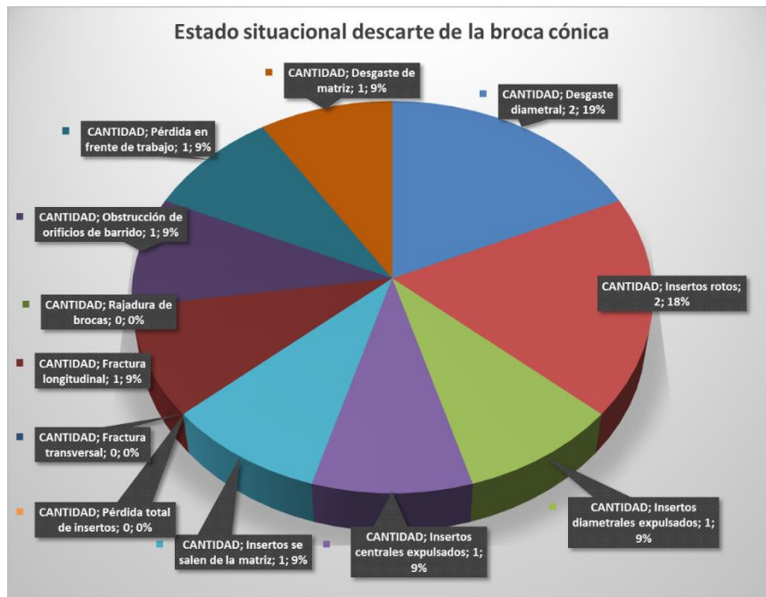
Figura 11. Estado situacional de los tipos de descarte de la broca cónica utilizadas en la Galería 5240 – S, Nivel 230 Tomada del Área de Operaciones Mina de la Unidad Minera Vicus (11)
