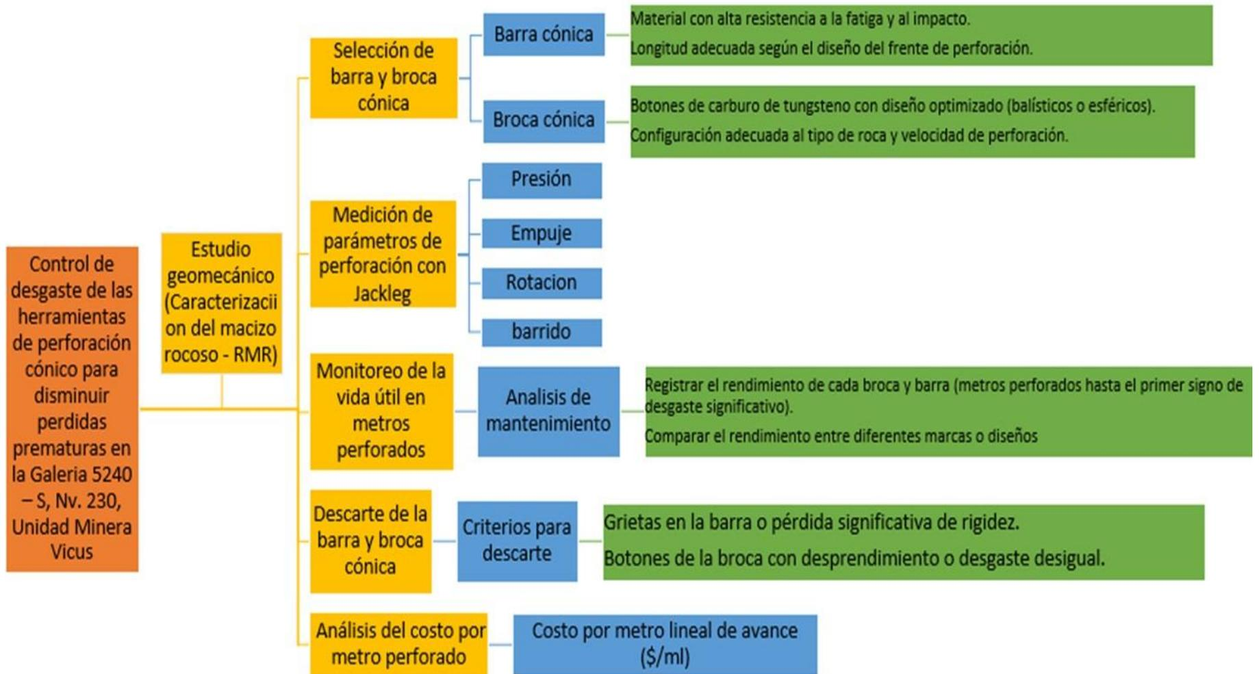
Figura 2. Control de desgaste de las herramientas de perforación cónica para disminuir pérdidas prematuras en la Galería 5240 – S, Nv. 230, Unidad Minera Vicus
