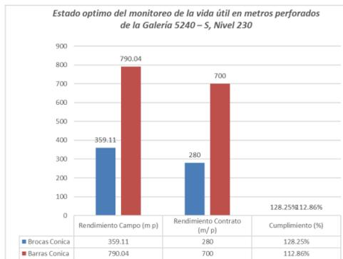
**Figura 10. Estado óptimo del monitoreo de la vida útil en metros perforados de la Galería 5240 – S, Nivel 230**
