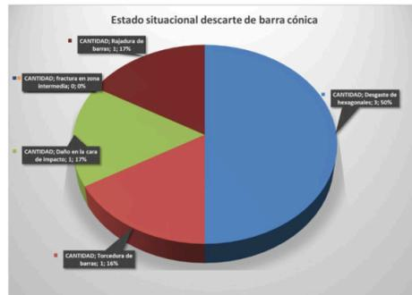
Figura 12. Estado situacional de los tipos de descarte de la barra cónica utilizadas en la Galería 5240 – S, Nivel 230
