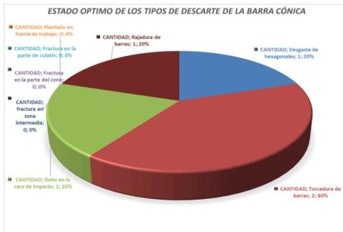
Figura 14. Estado óptimo de los tipos de descarte de la barra cónica utilizadas en la Galería 5240 – S, Nivel 230
