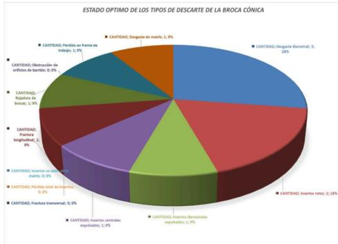
Figura 13. Estado óptimo de los tipos de descarte de la broca cónica utilizadas en la Galería 5240 – S, Nivel 230
