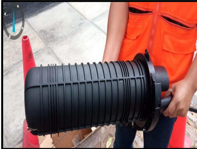
*Figura 59. Verificación del kit de empalme tipo domo de 96 hilos*
