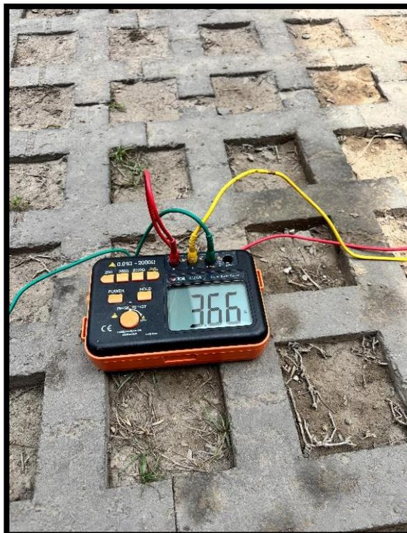
*Figura 25. Medición de ohmiaje del pozo a tierra*
