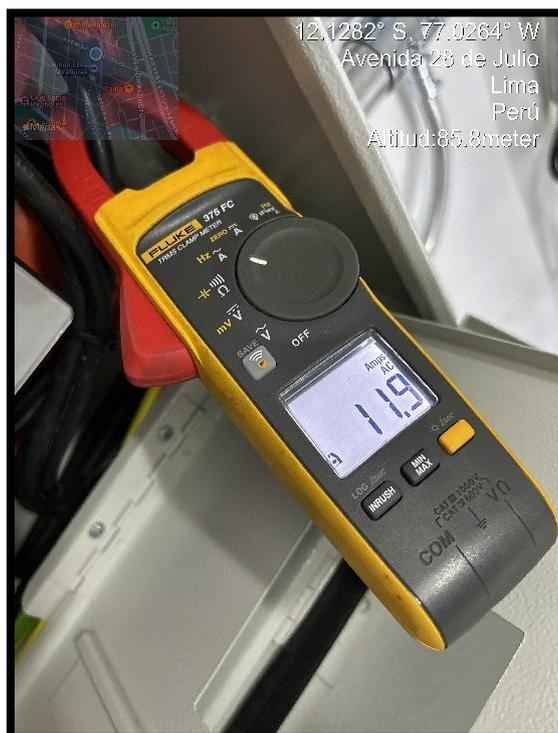
**Figura 87. Medición de corriente en la fase T en el tablero general del nodo**
