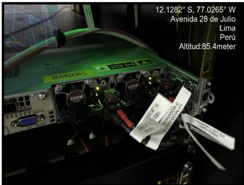
*Figura 78. Cables de energía fuente A y B del equipo servidor DELL*
