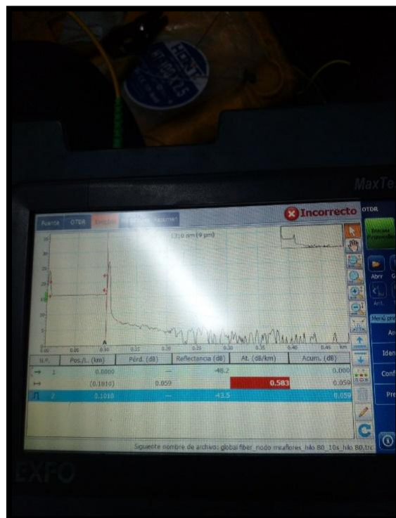
Figura 64. Medición de hilos empalmados con OTDR
