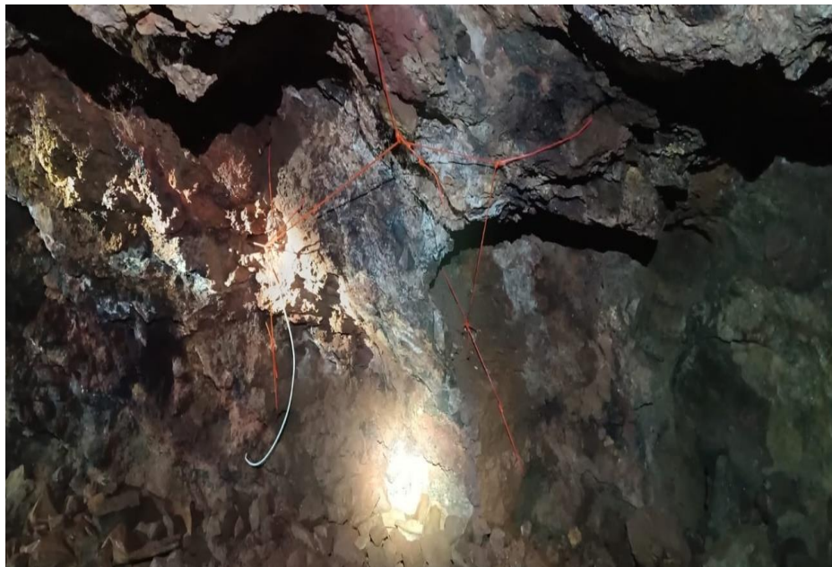
Verificación de carguío de taladros
