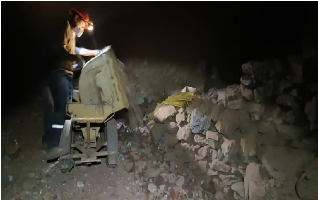
Relleno detrítico con carro minero
