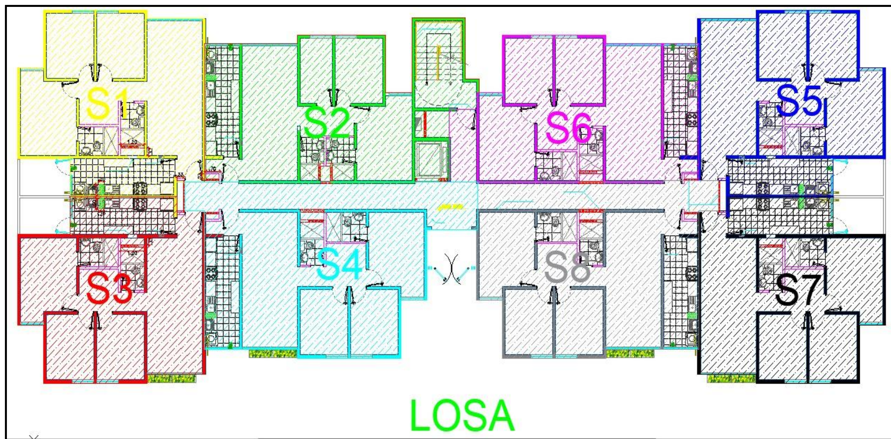
Figura 22: Sectorización de losa, edificio 5 Valle Blanco Premium
