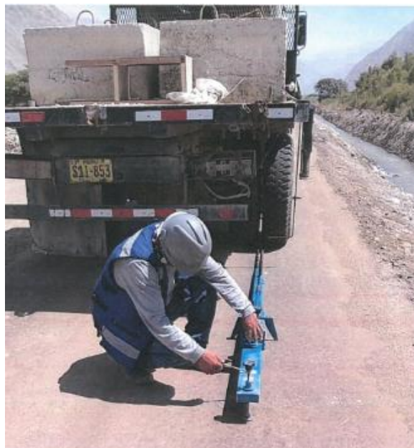
Figura 41. Ensayo de deflectometría con viga Benkelman
