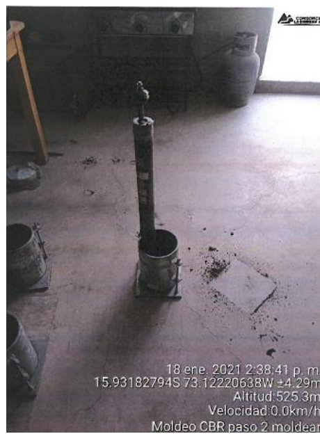
Figura 44. Ensayo de Proctor modificado
