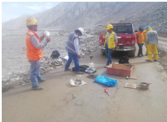
Figura 35. Ensayos de densidad de campo
