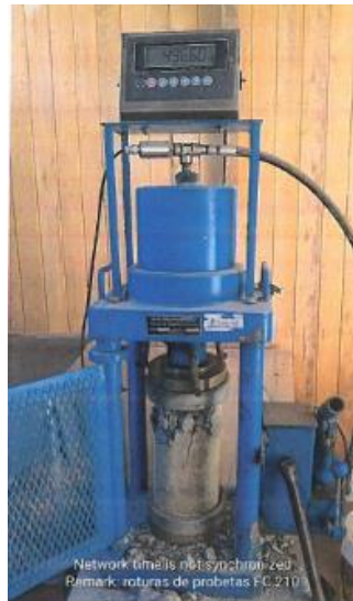
Figura 42. Ensayo de ruptura de briquetas
