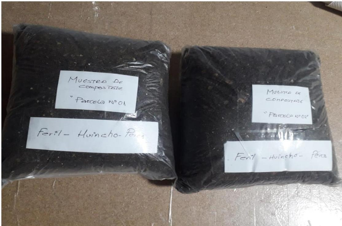
Después del cuarteo, se procedió a embolsar y etiquetar las muestras representativas de cada pila, asegurando su correcta identificación para el análisis posterior.
