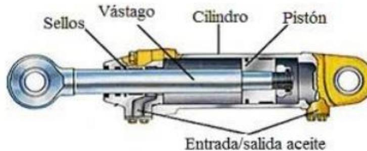
Figura 4. Corte de un cilindro hidráulico. Tomada de «Materiales y características técnicas de los cilindros hidráulicos», por Sumifluid, s. f.
