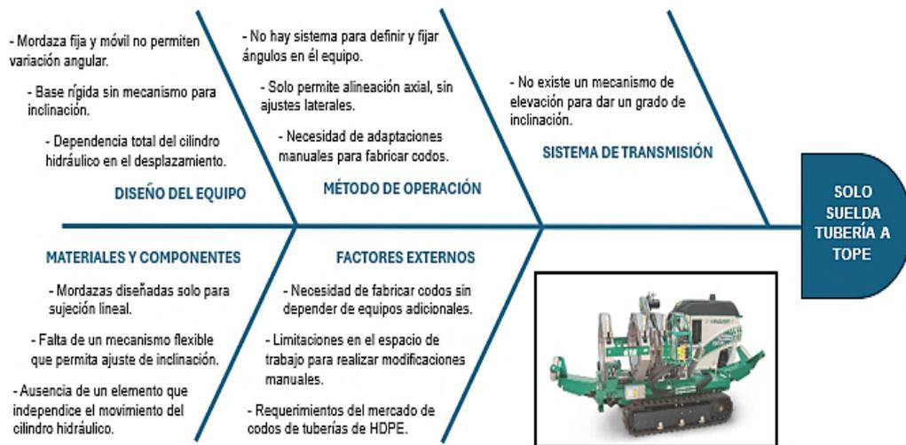
Figura 10. Diagrama de Ishikawa del equipo de termofusión. Elaboración propia.
