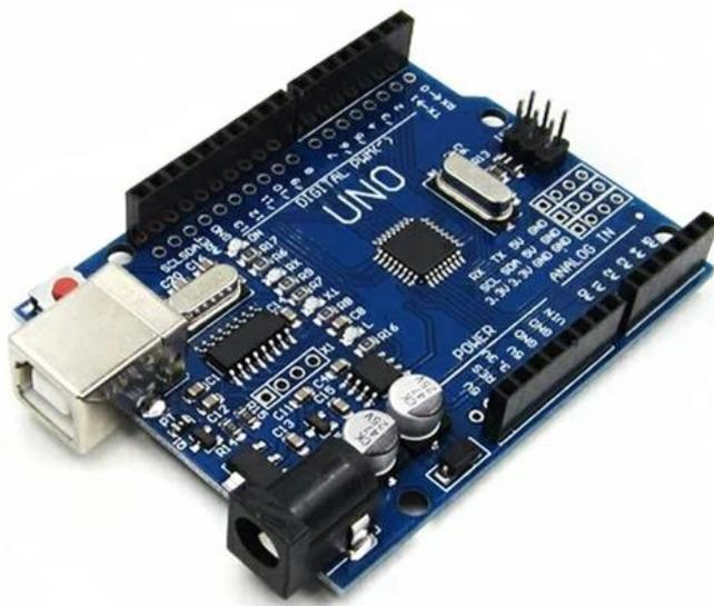
Figura 17. *Placa Arduino uno.*
