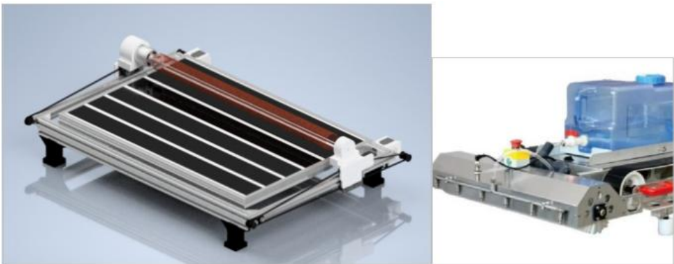
Figura 19. Solución 2 con rodillo de limpieza y tanque de agua conectado a la corriente.
