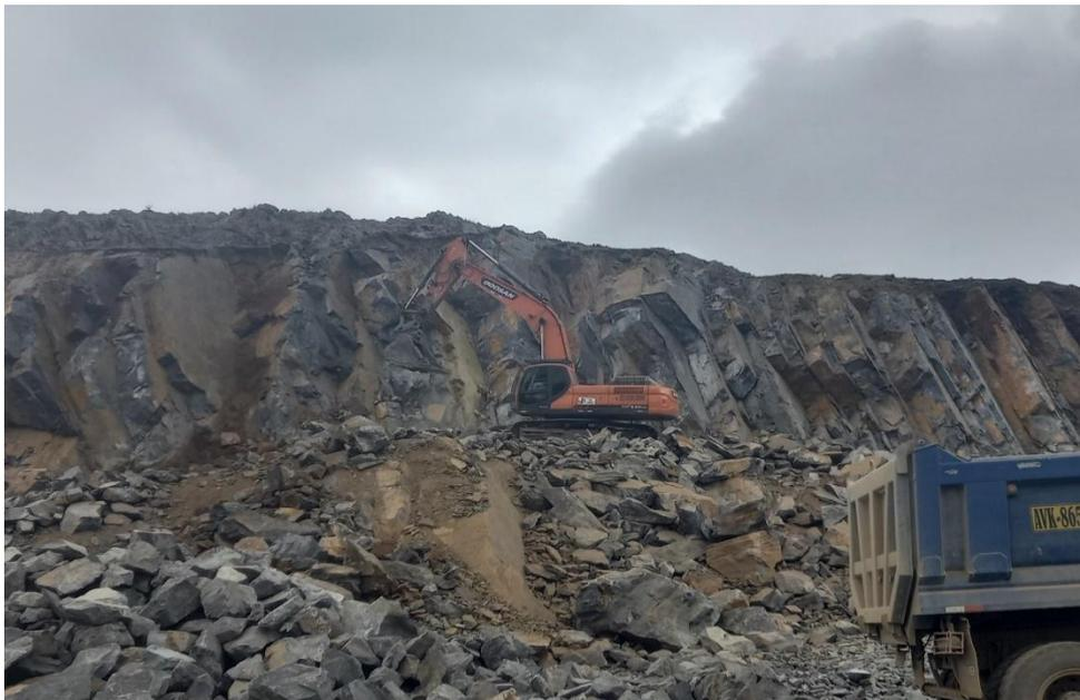
*Figura 20. Explotación de piedra por emprendedores de la comunidad percutado con martillo hidráulico*
