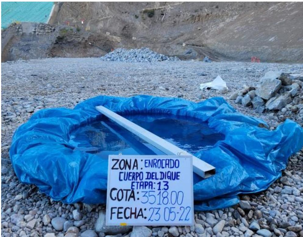
*Figura 17. Prueba por reemplazo de agua en roca método hoyo*
