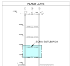
Imagen 109: PLANO DE ANDAMIOS EXTERIORES COLOCADOS SOBRE LA TREPA, TC.05 (Área: ULMA)
