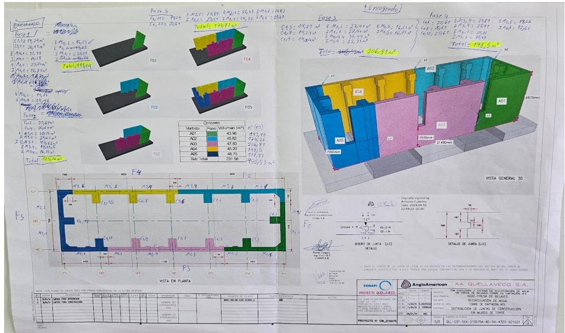
Imagen 22: Programación de los vaciados de concreto del Nivel 1, TC.05
