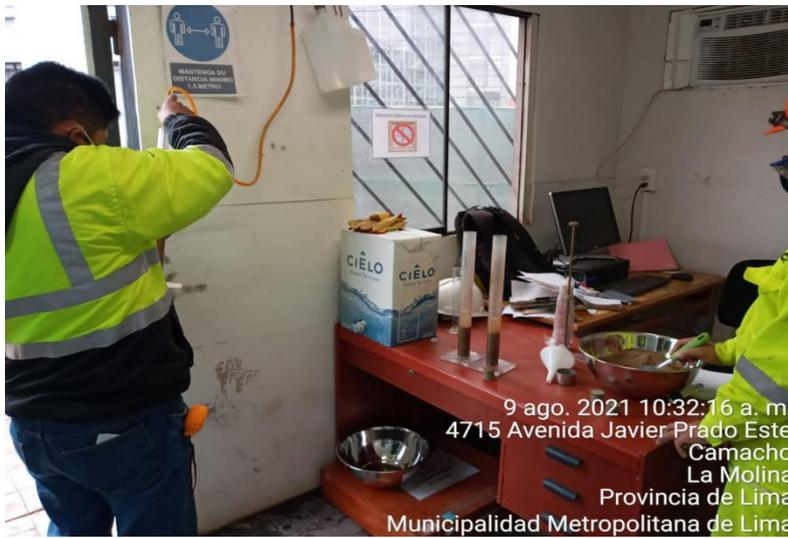
*Fuente: Elaboración propia***Figura 28.***Realización de ensayo Proctor modificado según la norma MTC E115*
