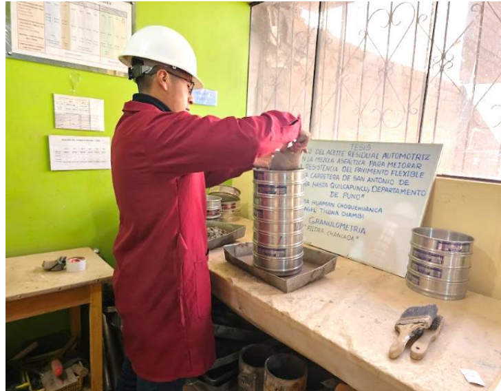
Figura 20. Tamizado del agregado para el ensayo de granulometría.
