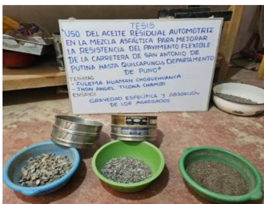
Las imágenes muestran el procedimiento realizado del ensayo de gravedad específica y absorción de los agregados
