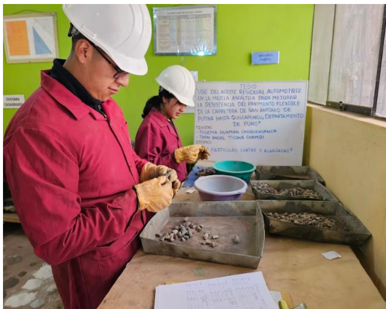
Figura 28. Determinación de partículas chatas y alargadas
