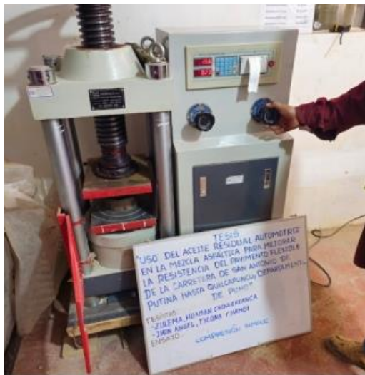
Las imágenes muestran el ensayo a la compresión realizado a las probetas asfálticas
