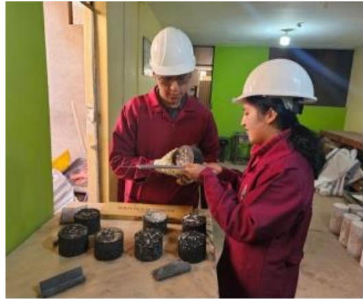
Las imágenes muestran la elaboración de las probetas asfálticas antes de ser usadas en los ensayos.
