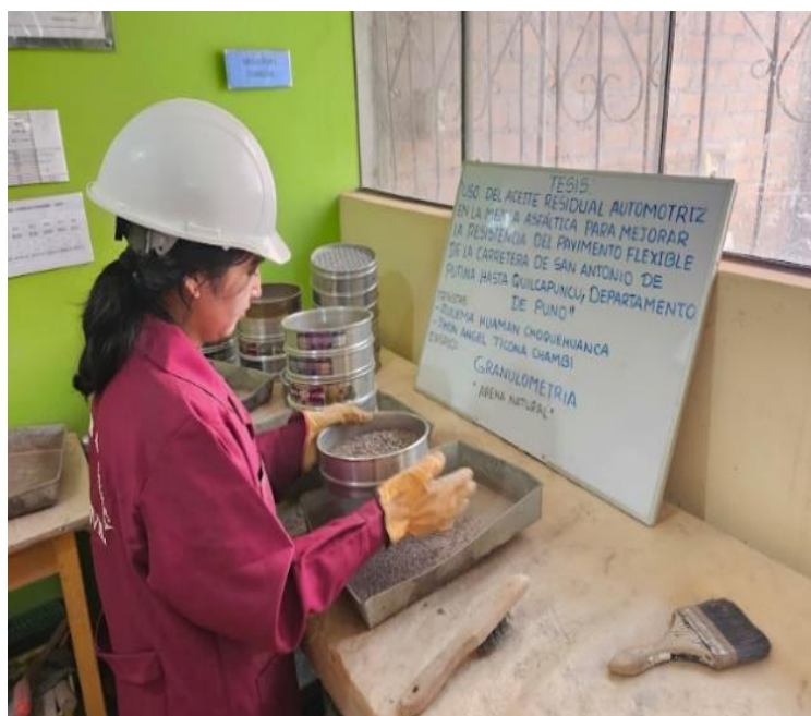
Figura 21. Determinación de la distribución de partículas del agregado.
