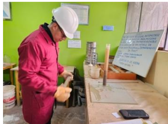
La imagen muestra la separación de las partículas chatas y alargadas
