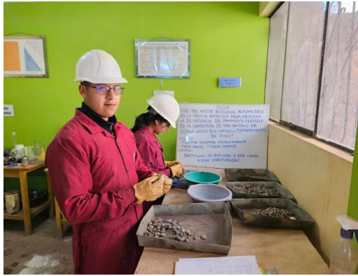
La imagen muestra la separación de las partículas chatas y alargadas
