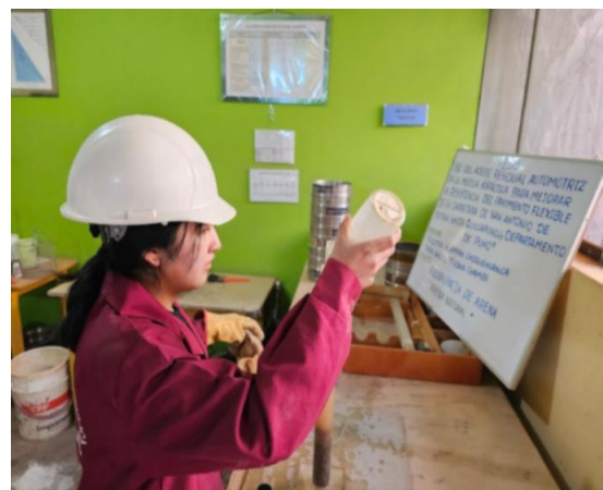
Las imágenes muestran el procedimiento de los ensayos realizados a la equivalencia de arena.
