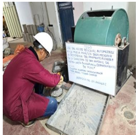
Las imágenes muestran el procedimiento realizado en el ensayo de agresión de los ángeles
