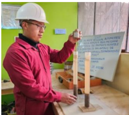
Las imágenes muestran el procedimiento de los ensayos realizados a la equivalencia de arena.
