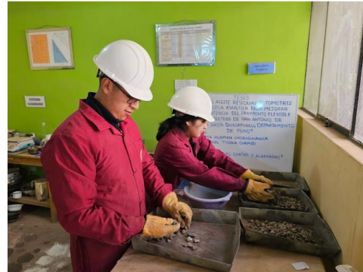
La imagen muestra la separación de las partículas chatas y alargadas
