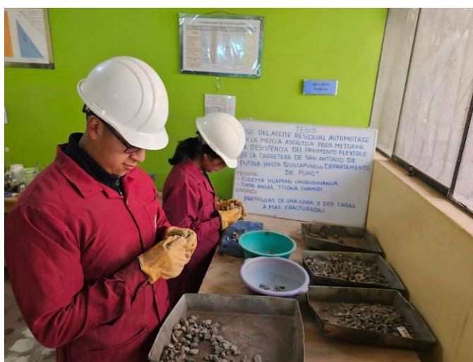
Figura 29. Determinación de partículas fracturadas.
