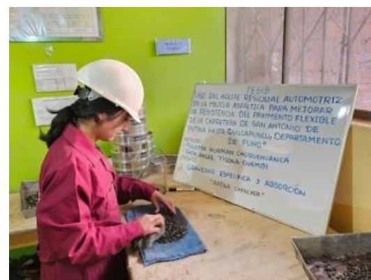
Las imágenes muestran el procedimiento realizado del ensayo de gravedad específica y absorción de la piedra chancada.
