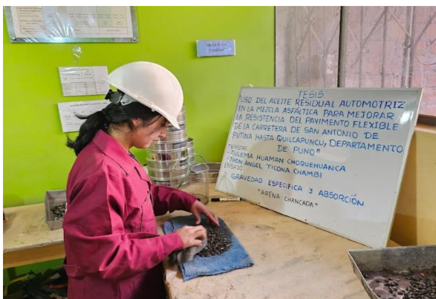
Figura 27. Ensayo de absorción y gravedad específica.
