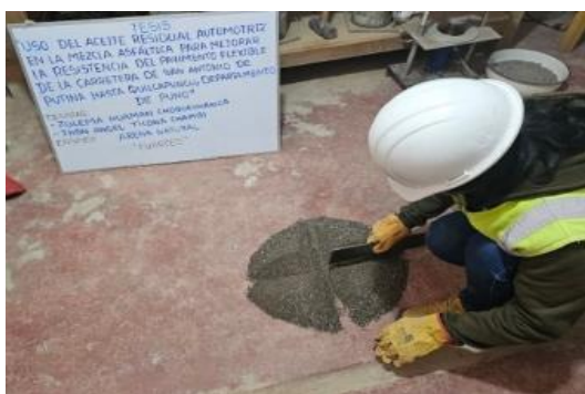
Las imágenes muestran el procedimiento realizado del ensayo de gravedad específica y absorción de los agregados
