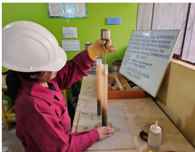
Figura 30. Realización del ensayo equivalente de arena.
