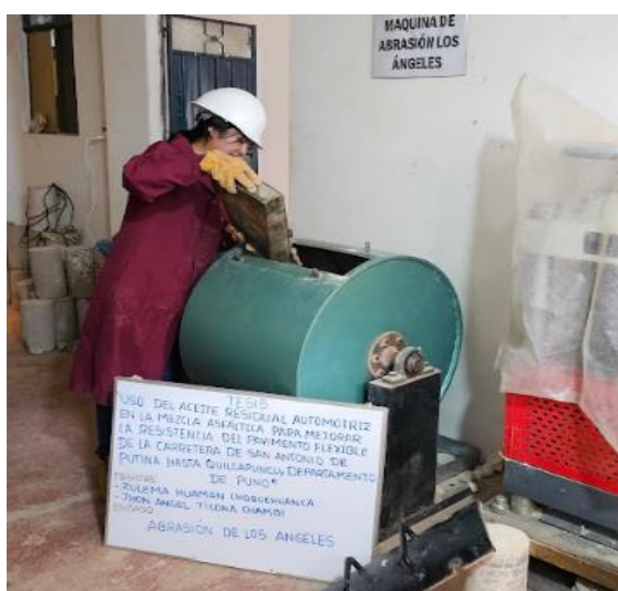
Figura 31. Ensayo Abrasión de los Ángeles.
