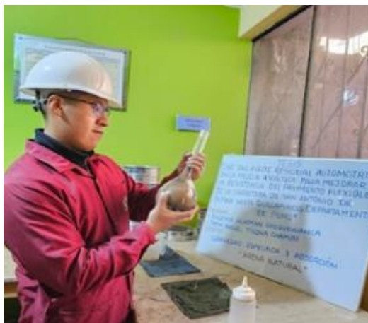
Las imágenes muestran el procedimiento realizado del ensayo de cono de arena.
