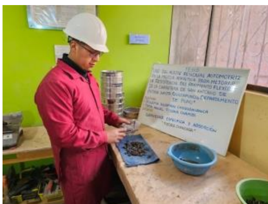
Las imágenes muestran el procedimiento realizado del ensayo de gravedad específica y absorción de la piedra chancada.
