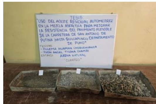
Las imágenes muestran el procedimiento realizado del ensayo de gravedad específica y absorción de los agregados
