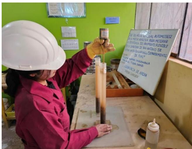
**Figura 30.** Realización del ensayo equivalente de arena.
