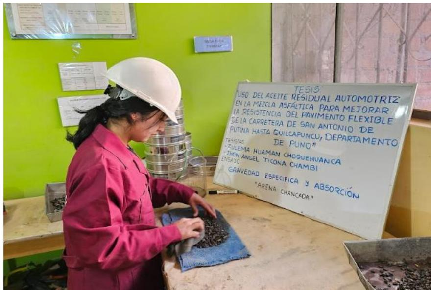
**Figura 27.** Ensayo de absorción y gravedad específica.
