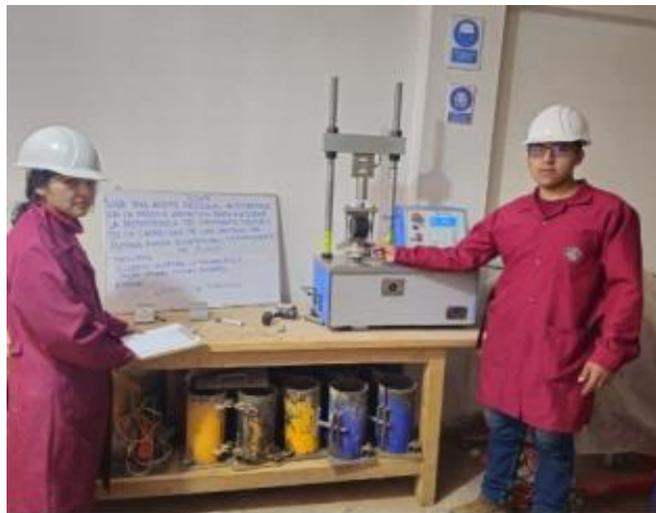
Las imágenes muestran el ensayo a la tracción realizado a las probetas asfálticas
