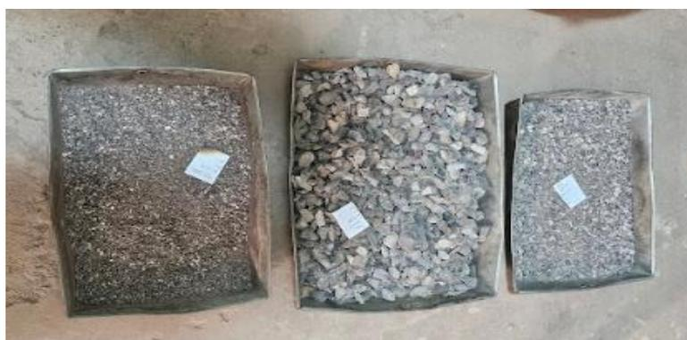
**Figura 19.** Lavado del agregado grueso por el tamiz # 200.
