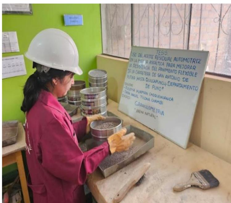
**Figura 21.** Determinación de la distribución de partículas del agregado.
