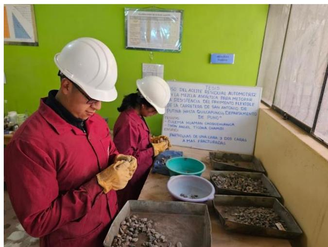
**Figura 29.** Determinación de partículas fracturadas.
