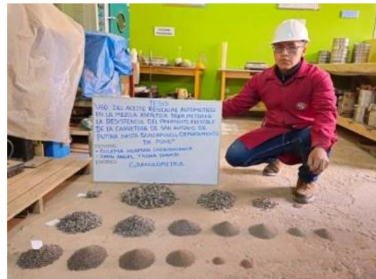
Las imágenes muestran el proceso del ensayo granulométrico realizado a los agregados.
