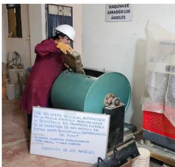
**Figura 31.** Ensayo Abrasión de los Ángeles.
