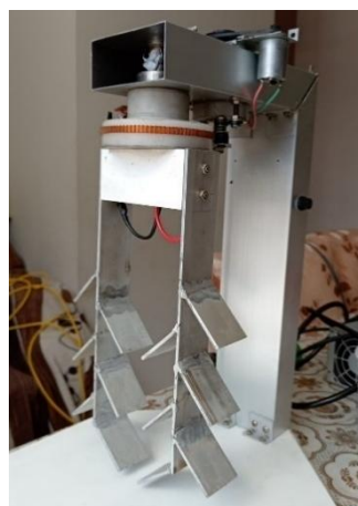
Figura 14. Electrodo instalados en el soporte del sistema.
