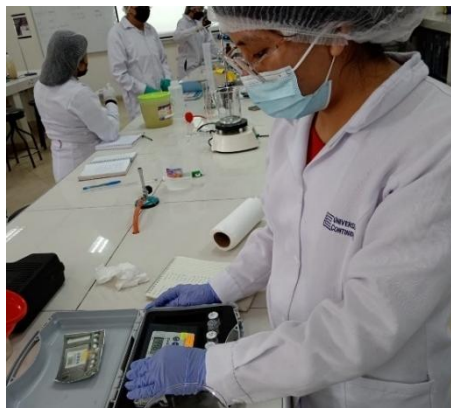
Figura 25. Medición de turbidez inicial.
