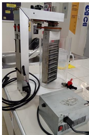
Figura 21. Prototipo final del sistema de electrocoagulación.
