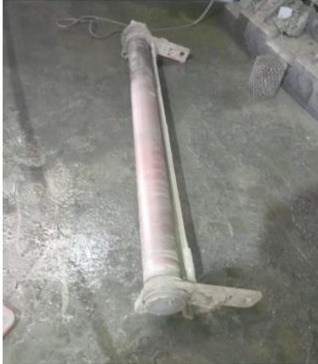
**Figura 11.** Desmontaje de rodillo para dimensionamiento de sistema
