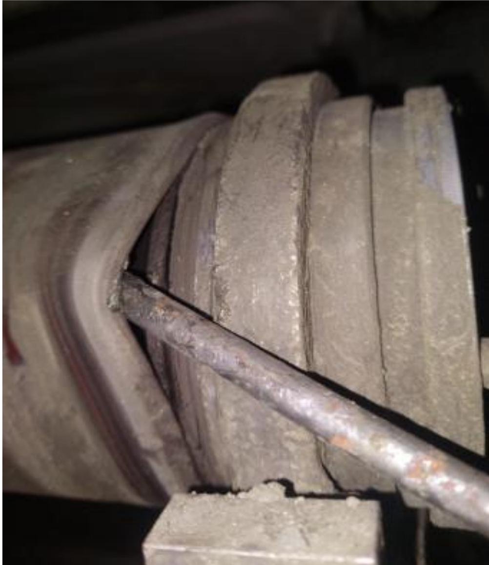
**Figura 10.** Desgaste de forro del rodillo detectado
