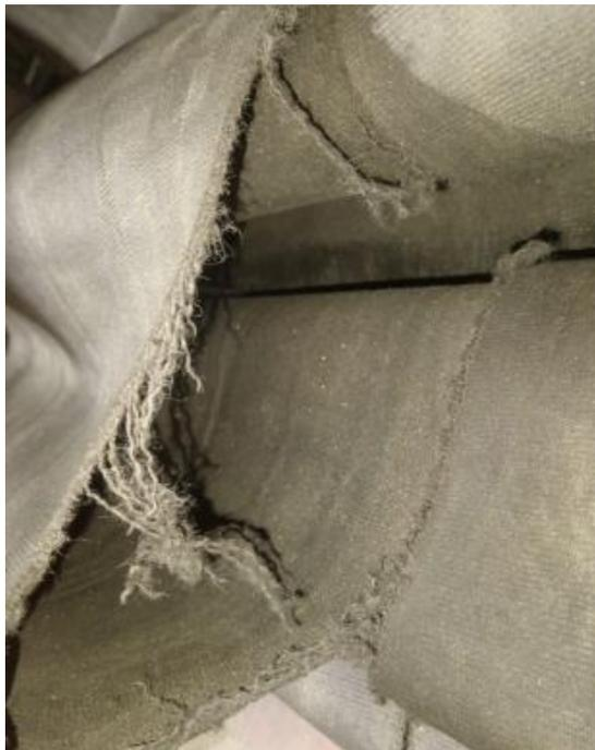
**Figura 5.** Rotura producida por desgaste de tela filtrante
