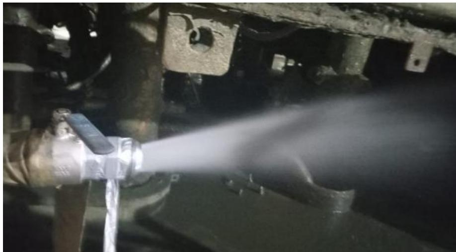
**Figura 18.** Evaluación de funcionamiento de sistema de lavado
