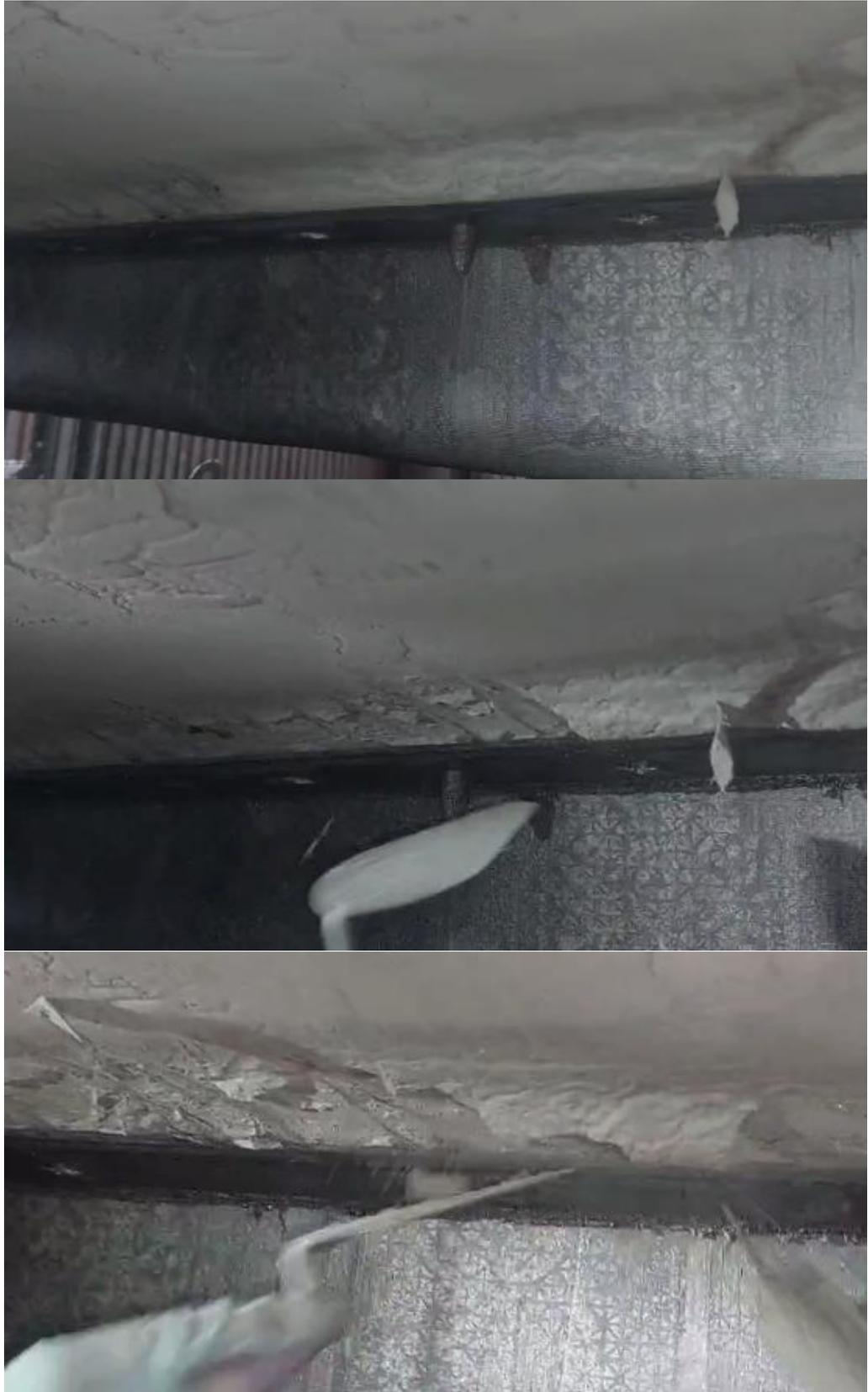
**Figura 9.** Proceso de retiro de calicha acumulada en raspador
