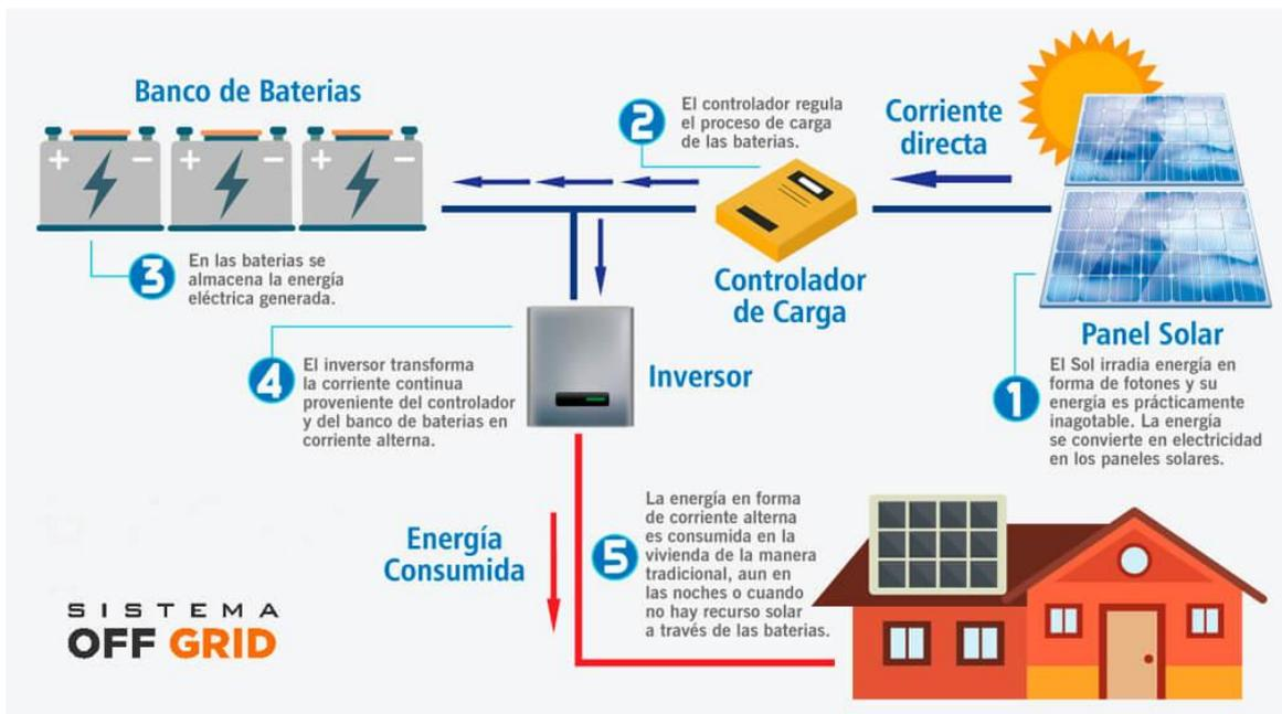
Figura 16. *Sistema OFF GRID. Tomada de: Guía para el dimensionamiento de sistemas solares fotovoltaicos aislados de la red (Off-Grid)*, por Pérez, J., Universidad de Antioquia, 2019
