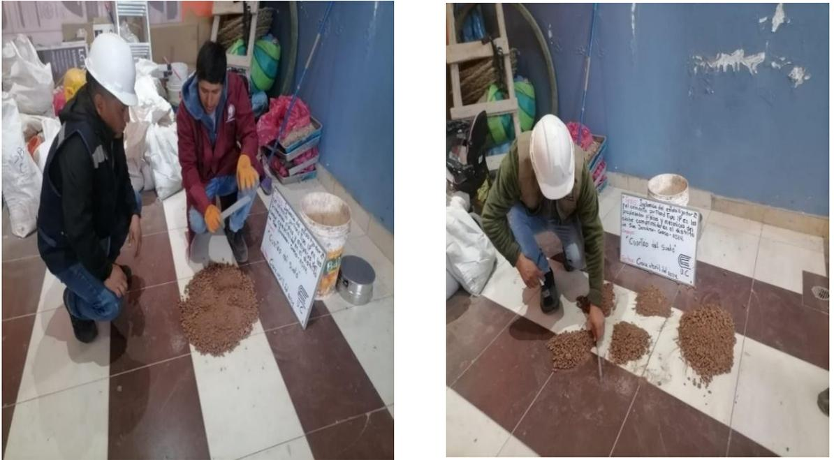
Nota: El cuarteo para obtener una submuestra representativa del suelo, consiste en dividirlo en partes iguales y eliminar secciones de forma sistemática, asegurando la uniformidad del material para fabricar adobes comprimidos.
