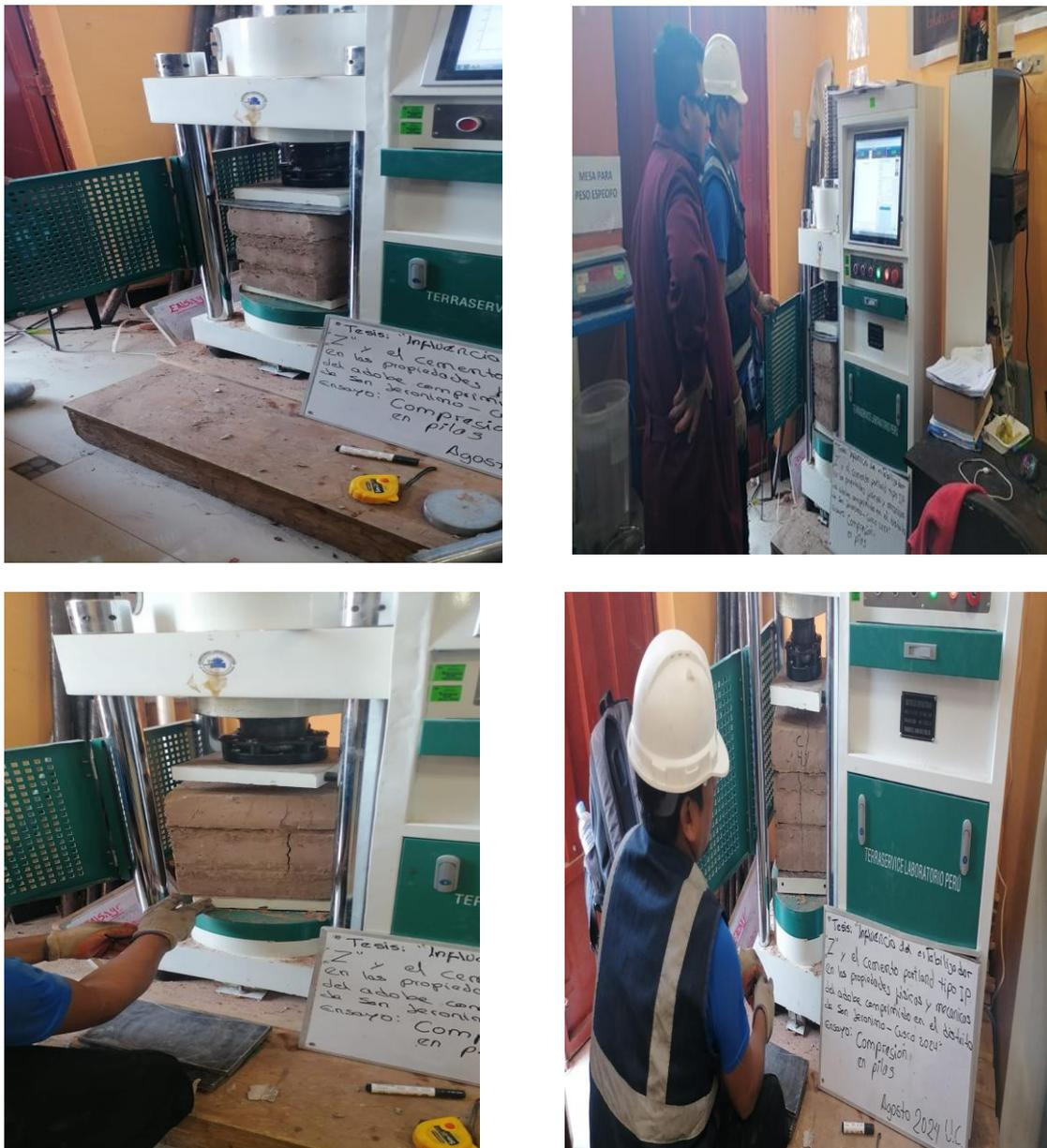
Nota: El ensayo de compresión de pilas mide la resistencia vertical de muretes de adobe, evaluando la unión entre adobe y mortero, según lo exige la Norma E.080, Art. 8.4.
