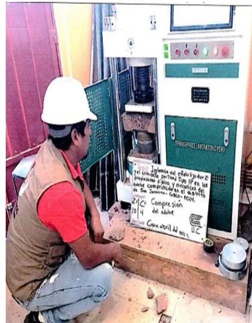
Nota: El ensayo de compresión de adobes mide su resistencia mecánica bajo carga axial, siendo clave para evaluar su capacidad estructural y cumplimiento con la Norma E.080.
