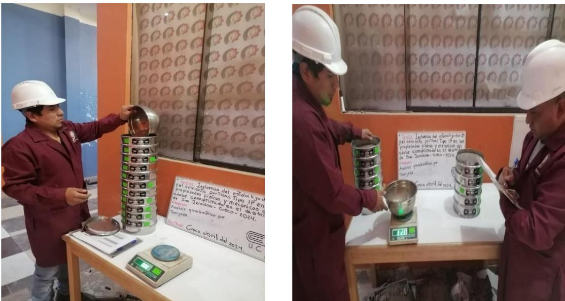
**Figura 14 (b).** Dispositivos de ensayo granulométrico
