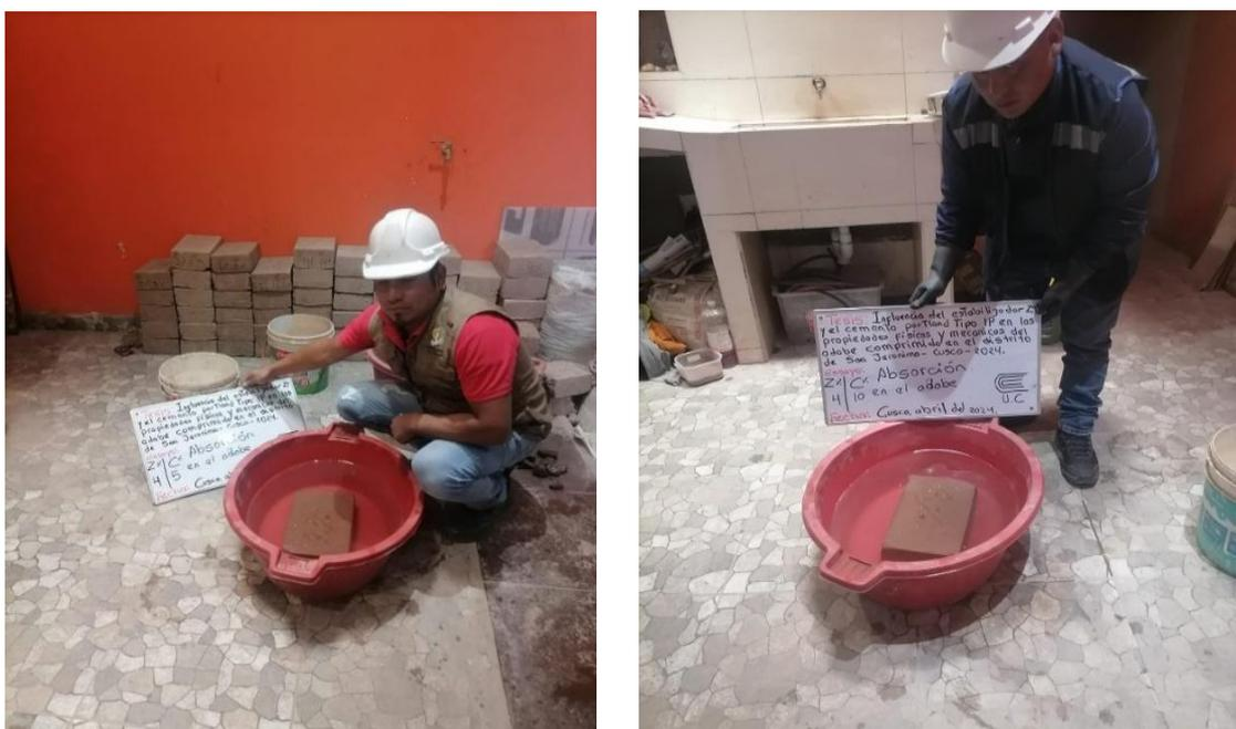
**Figura 16 (b).** Ensayo de Absorción de adobes
