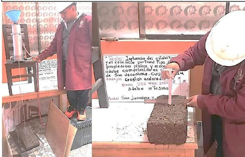
**EMM CON FINES DE DETERMINACION DE LA EROSION ACELERADA SWINBURNE (SAET) UNE 41410:2008**
