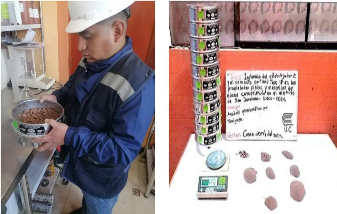
Nota: Los dispositivos de ensayo granulométrico, como tamices y balanzas, se usan para analizar la distribución de tamaños de partículas en un material, lo cual es crucial para evaluar su idoneidad en la fabricación de adobes comprimidos.
