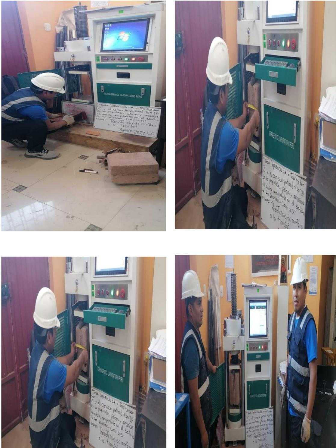
Nota: La resistencia a la tracción del mortero mide su capacidad para resistir esfuerzos de separación, según la Norma E.080, Art. 8.3.
