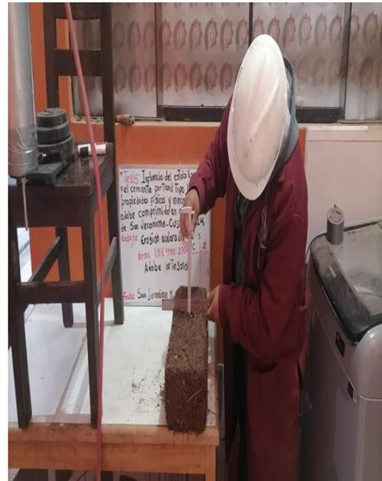
Nota: El ensayo de erosión acelerada mide la resistencia del adobe al agua, simulando lluvia intensa con un chorro controlado. Permite evaluar la durabilidad superficial y la eficacia de estabilizantes.
