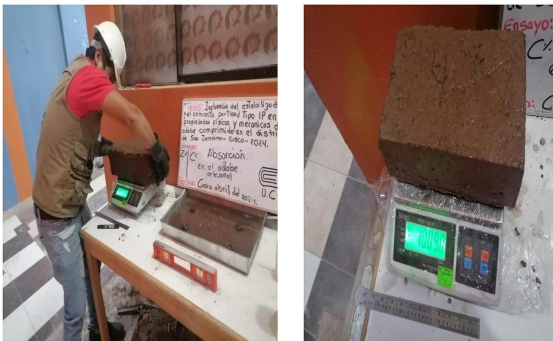
Nota: El ensayo de absorción de adobes mide cuánta agua puede absorber un bloque de adobe, evaluando su resistencia al agua y durabilidad.
