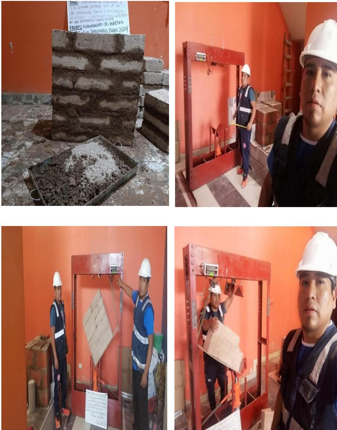
Nota: El ensayo de compresión diagonal mide la resistencia al corte de muretes de adobe ante cargas laterales, simulando sismos, según la Norma E.080.
