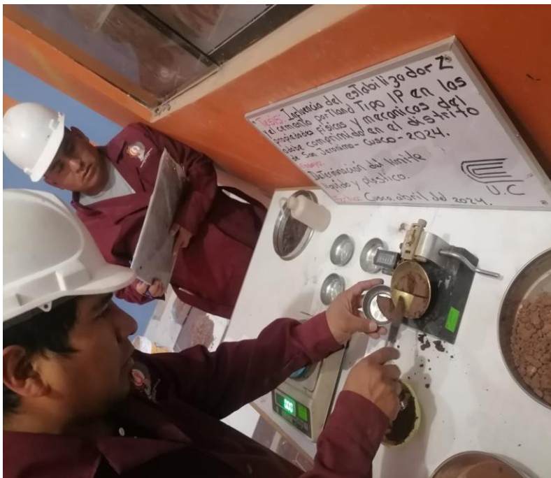
Figura 42. Análisis granulométrico - determinación del límite líquido
