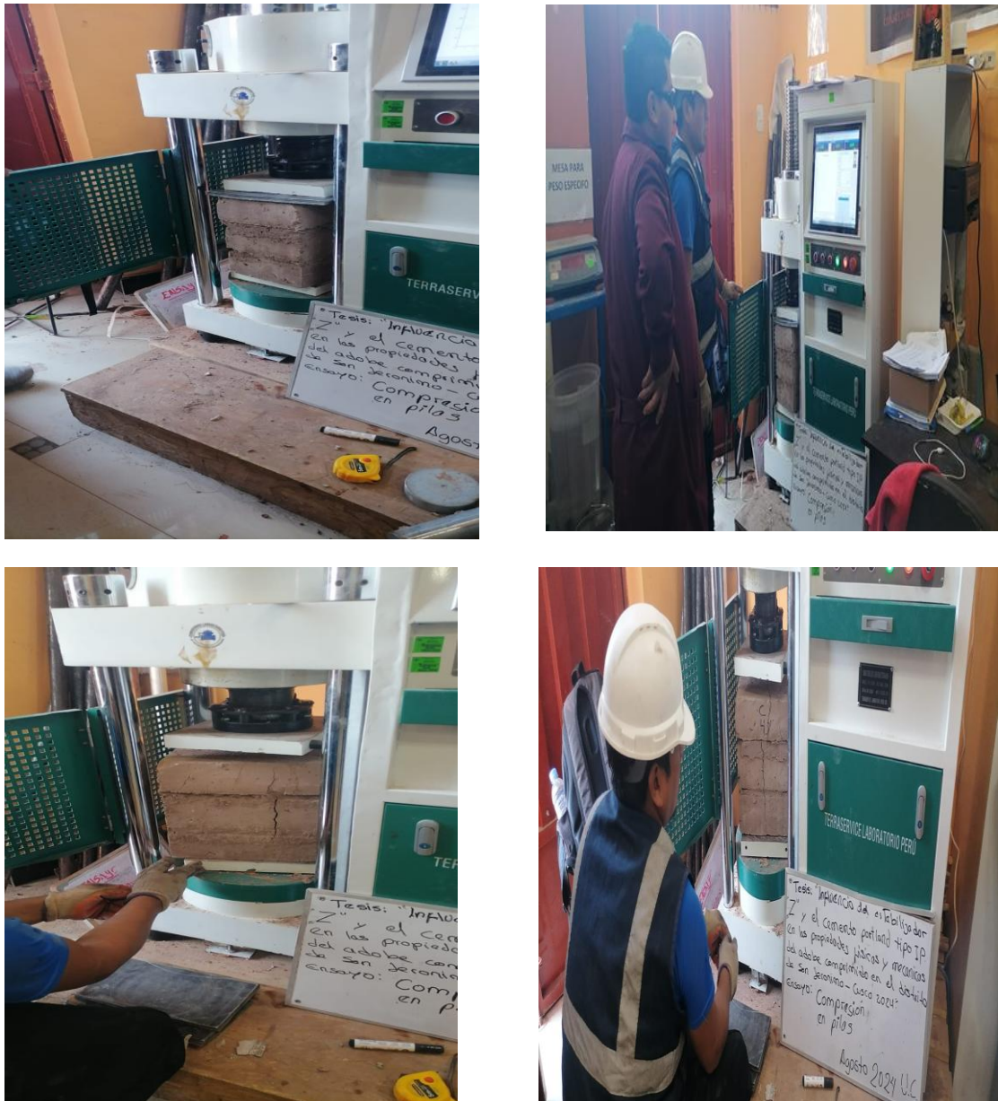
Figura 20. Ensayo de compresión de pilas en adobes
