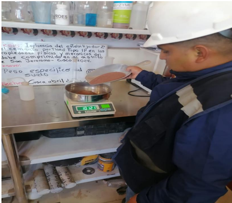
Figura 37. Análisis granulométrico – peso específico
