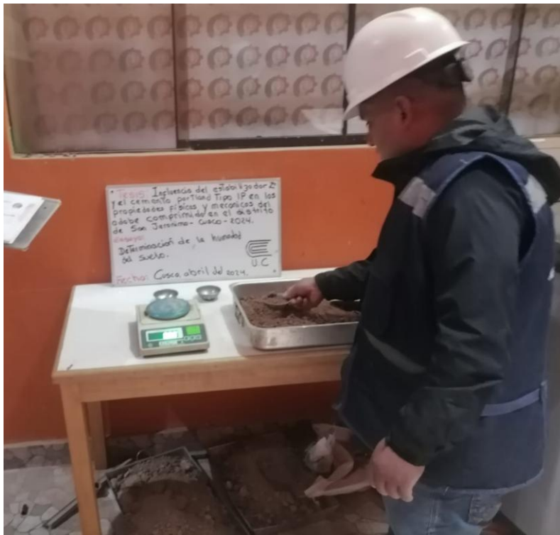
Figura 39. Análisis granulométrico - determinación de la humedad del suelo
