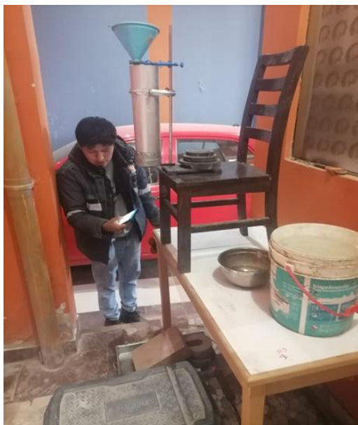
Figura 18. Ensayo de erosión acelerada
