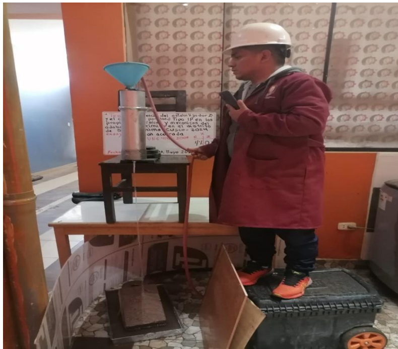
Figura 51. Ensayo de erosión (Pesado de unidades de adobes para determinar succión)
