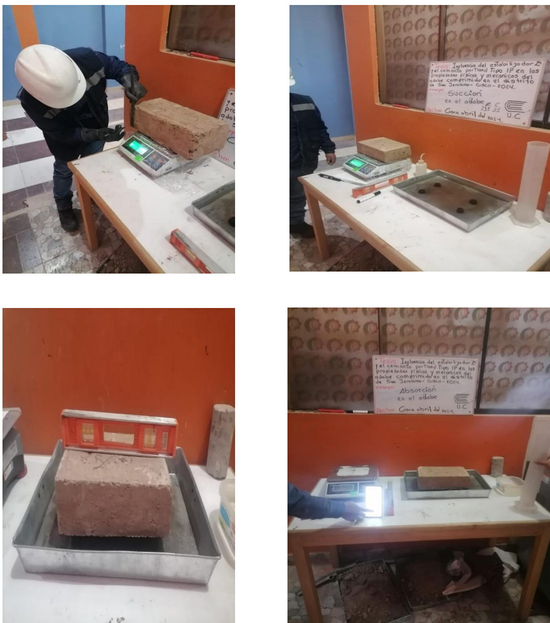
Figura 17. Obtención de datos de la succión de agua en adobes
