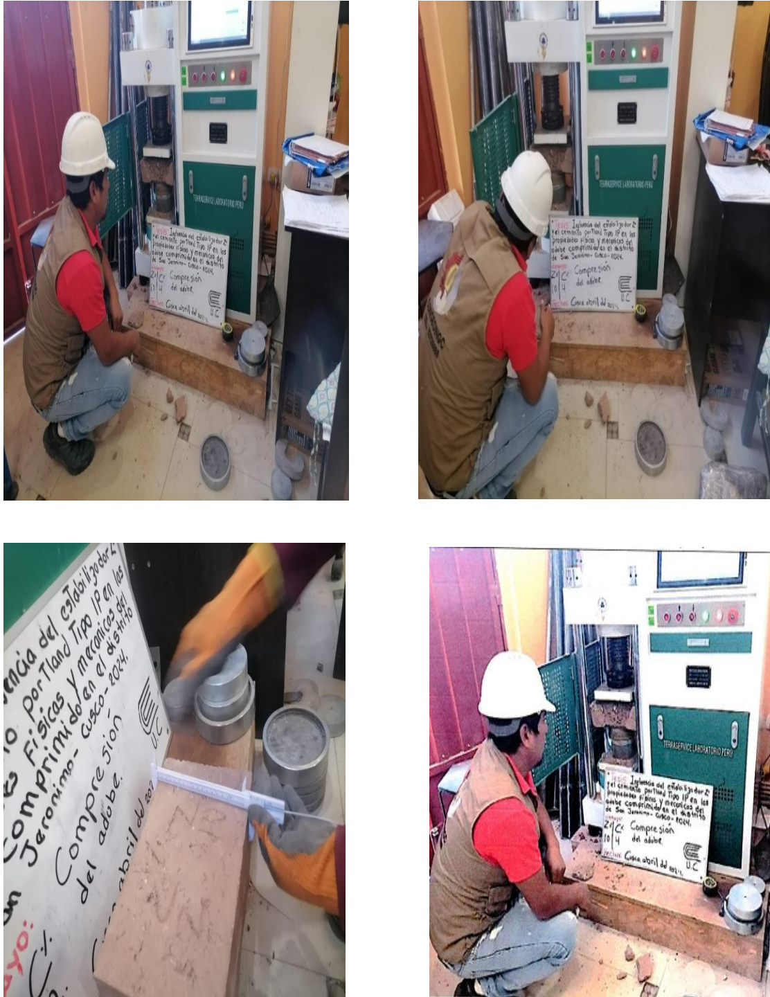
Figura 19. Ensayo de compresión de adobes
