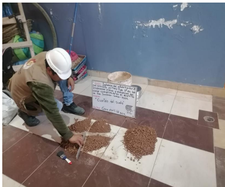
Figura 32. Análisis granulométrico cuarteo del suelo
