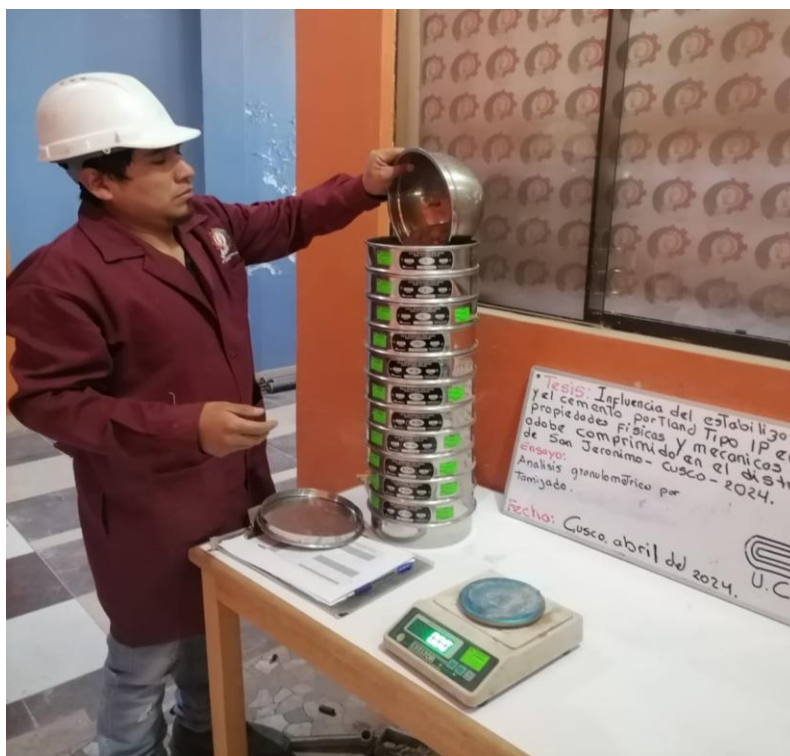
Figura 35. Análisis granulométrico por tamizado
