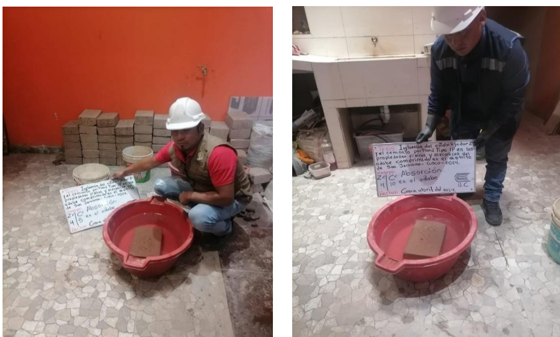
Figura 16 (a). Ensayo de Absorción de adobes
