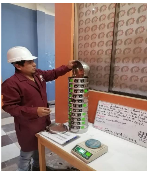
Figura 14 (a). Dispositivos de ensayo granulométrico
