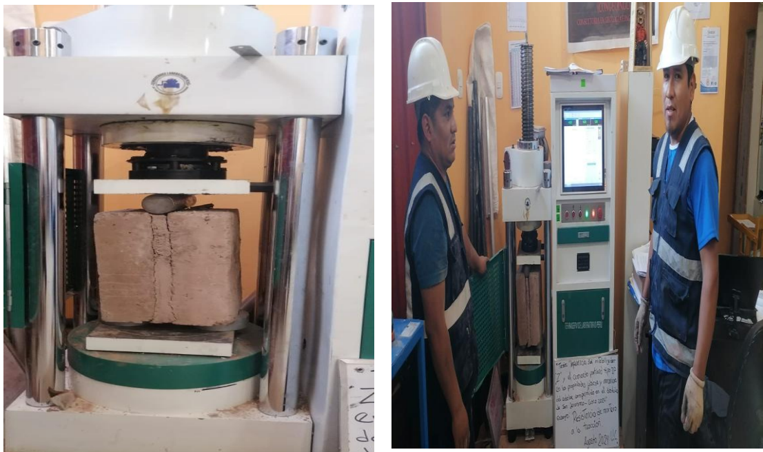
Figura 60. Ensayo de Resistencia a la tracción del mortero
