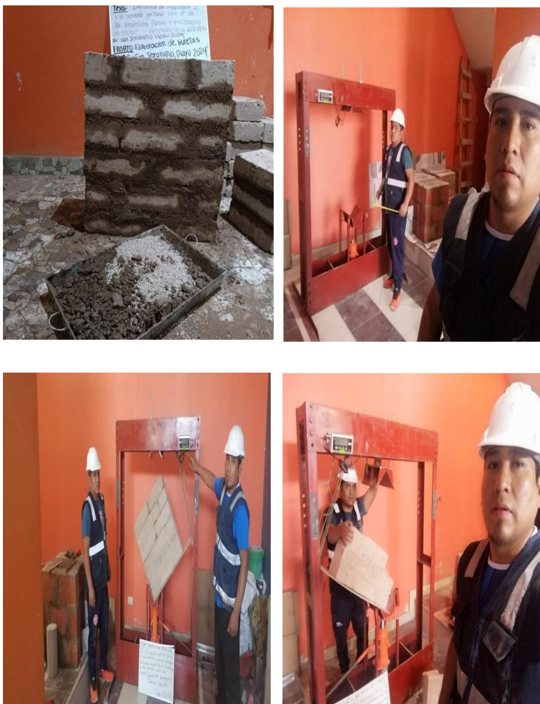
Figura 21. Ensayo de compresión diagonal de muretes de adobe
