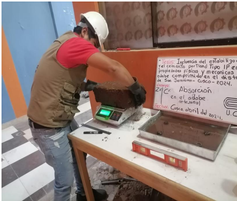
Figura 49. Pesado de unidades de adobes después de estar sumergidos
