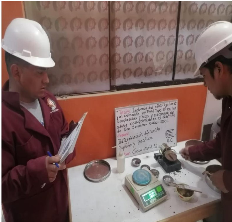
Figura 41. Análisis granulométrico - determinación del límite líquido
