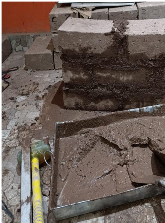
Figura 57. Elaboración de muretes de adobes para ensayo de compresión diagonal
