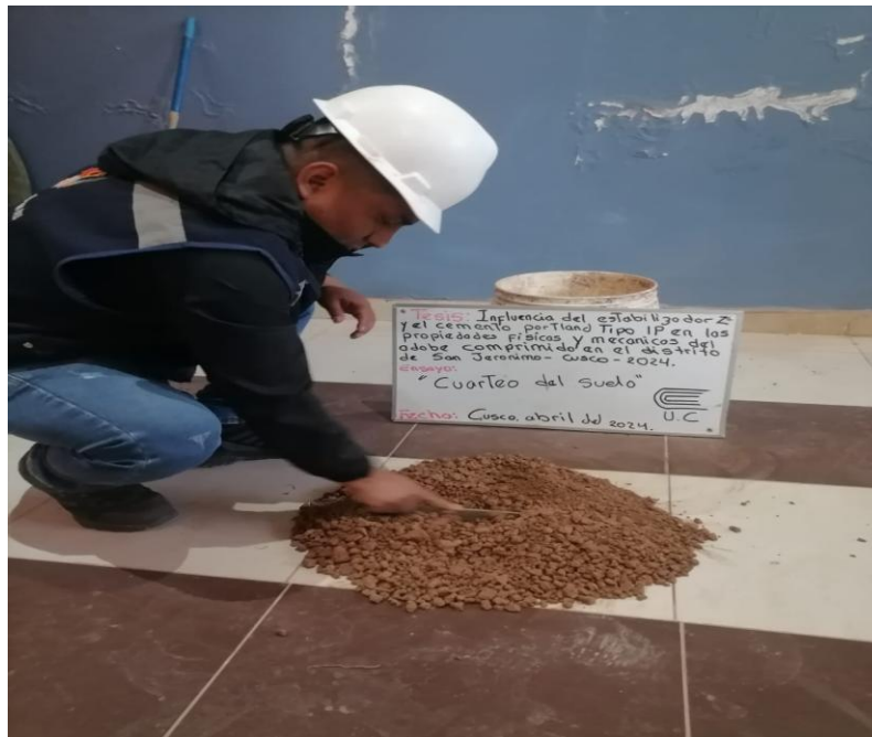
Figura 31. Análisis granulométrico cuarteo del suelo
