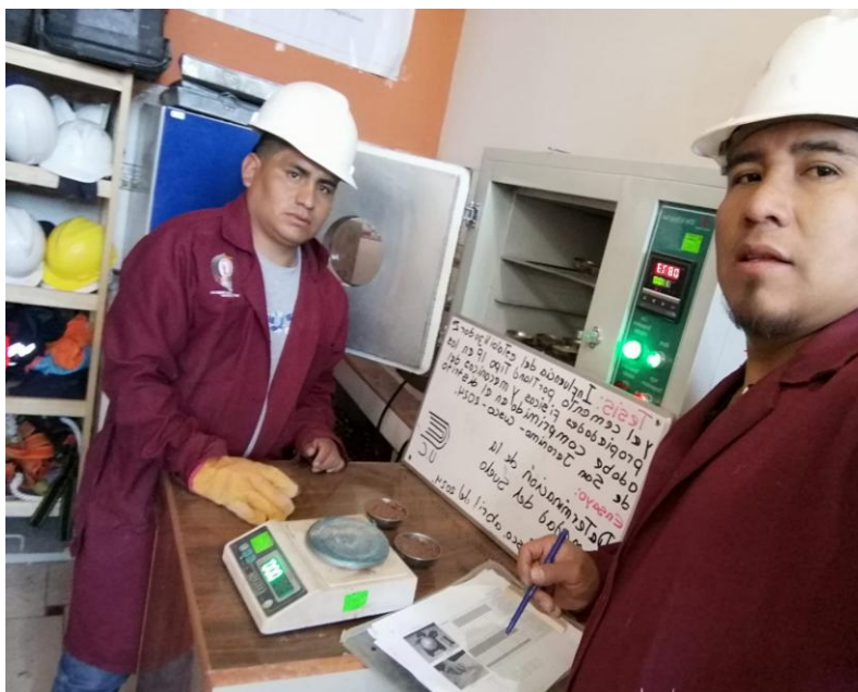
Figura 40. Análisis granulométrico – determinación de la humedad del suelo
