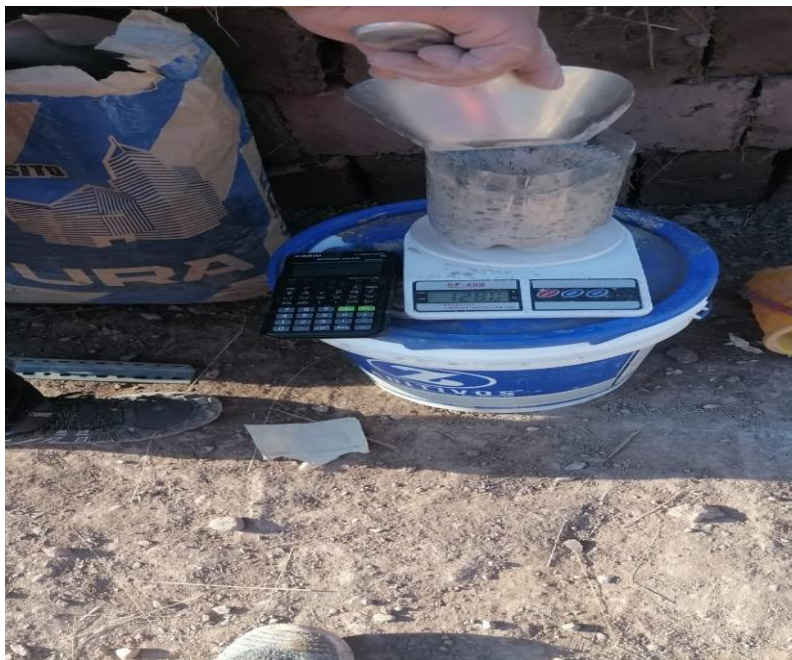
Figura 46. Pesaje de cemento Portland (tipo IP) para el mezclado con tierra para adobes
