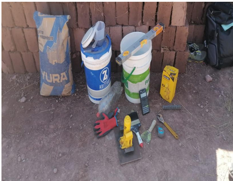
Figura 44. Materiales para la fabricación del adobe
