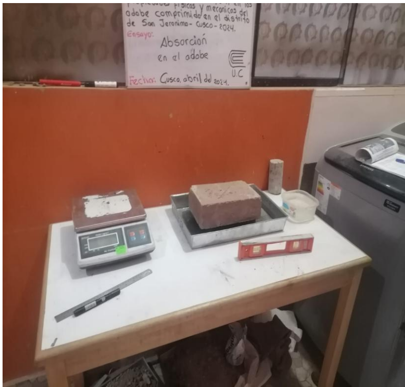
Figura 50. Ensayo de adsorción de unidades adobes sumergidos
