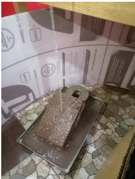
Figura 52. Ensayo de Resistencia a la erosión acelerada en unidades adobes
