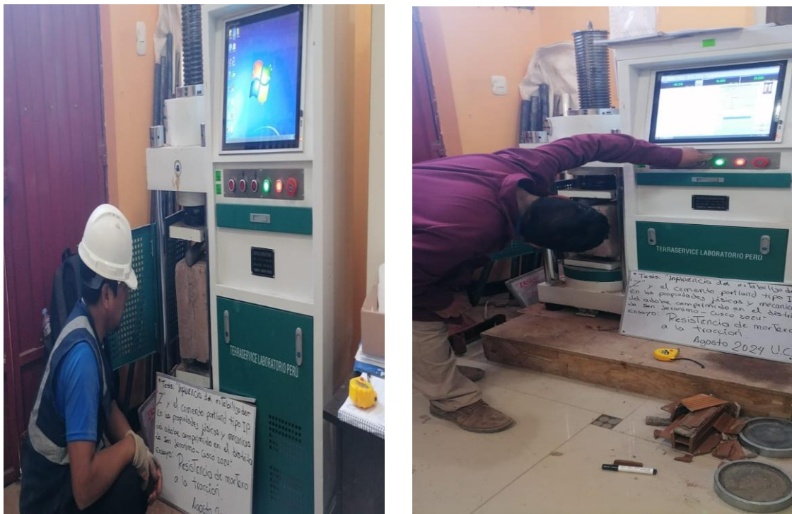
Figura 59. Ensayo de Resistencia a la tracción del mortero
