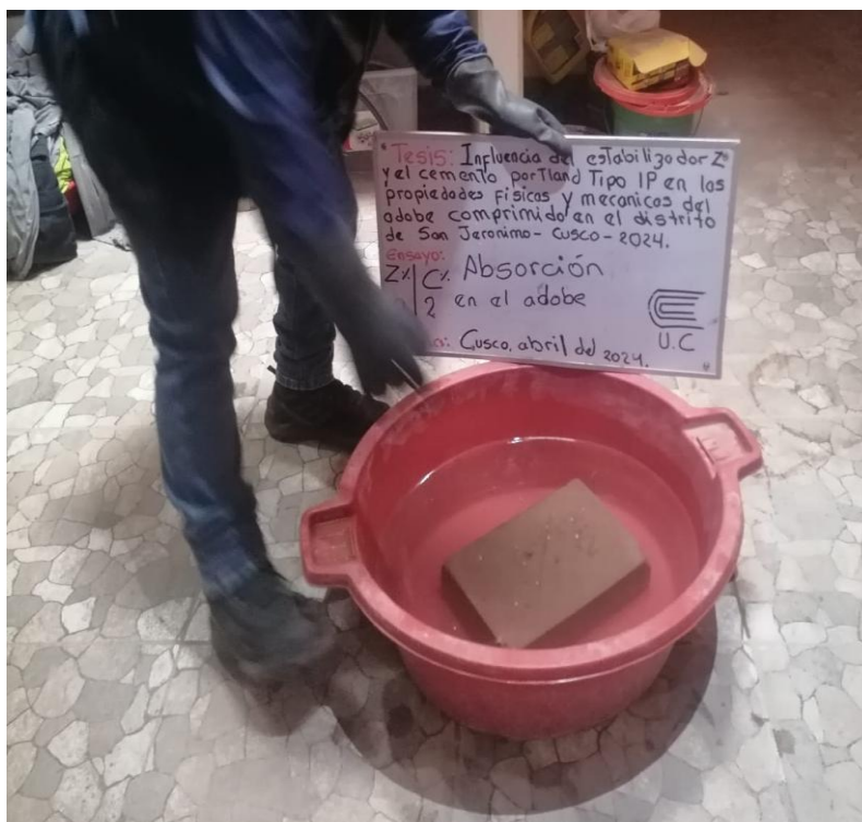
Figura 48. Ensayo de absorción de unidades de adobe
