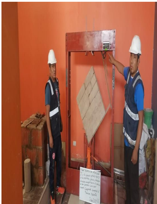
Figura 58. Ensayo realizado de corte diagonal en muretes
