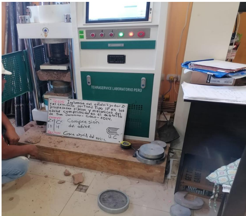
Figura 54. Verificación de corte producido en unidades adobes
