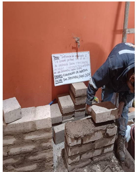
Figura 57. Elaboración de muretes de adobes para ensayo de compresión diagonal
