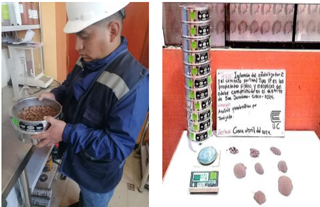
Figura 14 (b). Dispositivos de ensayo granulométrico
