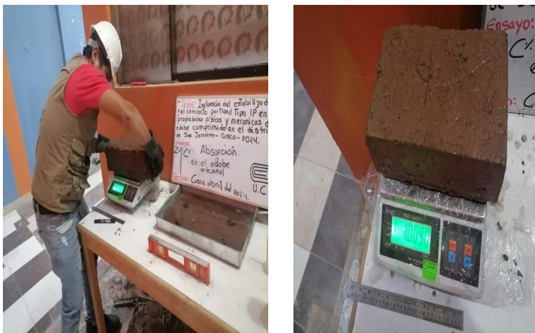
Figura 16 (b). Ensayo de Absorción de adobes
