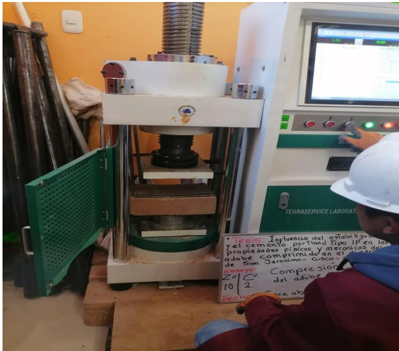
Figura 53. Ensayo de resistencia a la compresión en unidades adobes
